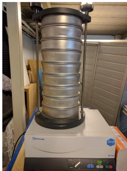
Figur 46: Siktemaskin for utførelse av sikteprøve (Foto: Sigmund Wiig Petersen).
