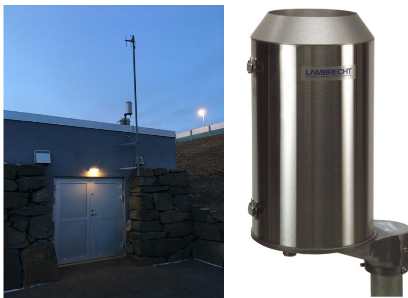
Figur 40: Venstre: nedbørmåler (Foto: Håkon Eskeland Børtveit) Høyre: produktbilde (Lambrecht, u.a.).
