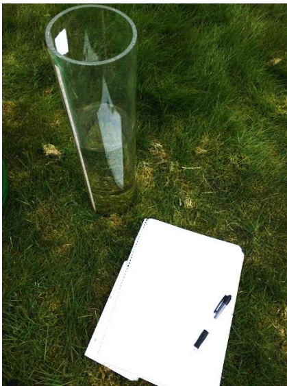
Figur 45: Venstre: MPD infiltrasjonskylindere for infiltrasjonsmålinger. Høyre: Utstyr (Foto: Håkon Eskeland Børtveit).
