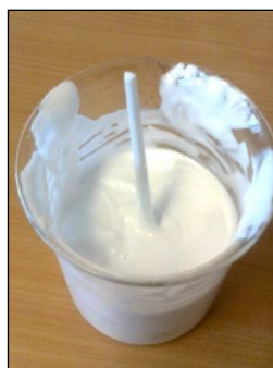
Figur 1. 70 vol % sjøvann-i-soyaolje emulsjon ved 10 °C og tilsynelatende viskositet ca 15000 cP (mPas) ved et skjær på 10 sek -1 .
