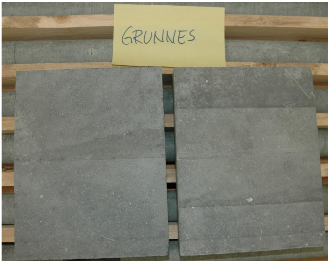
Figur A. 14: Stein fra Grunnes brukt i XRD analysen og hardhetsmålinger.
