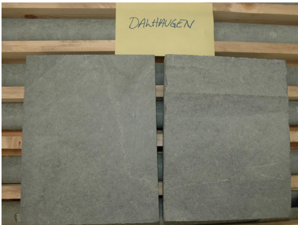
Figur A. 13: Stein fra Dalhaugen brukt i XRD analysen og hardhetsmålinger.
