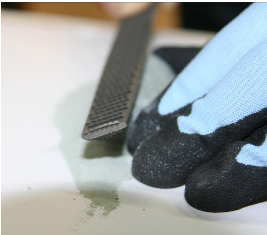
Figur 10: Innsamling av pulver fra kleberstein for videre XRD-analyse.
