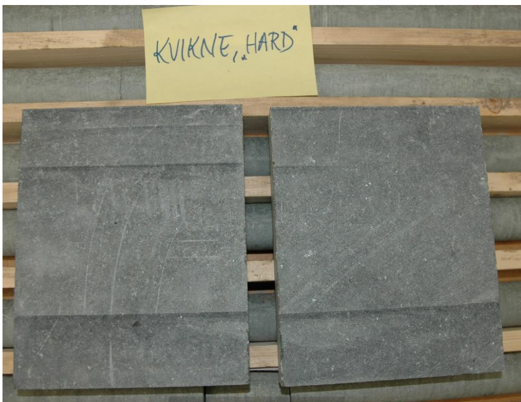
Figur A. 15: Stein fra Kvikne (hard) brukt i XRD analysen og hardhetsmålinger.
