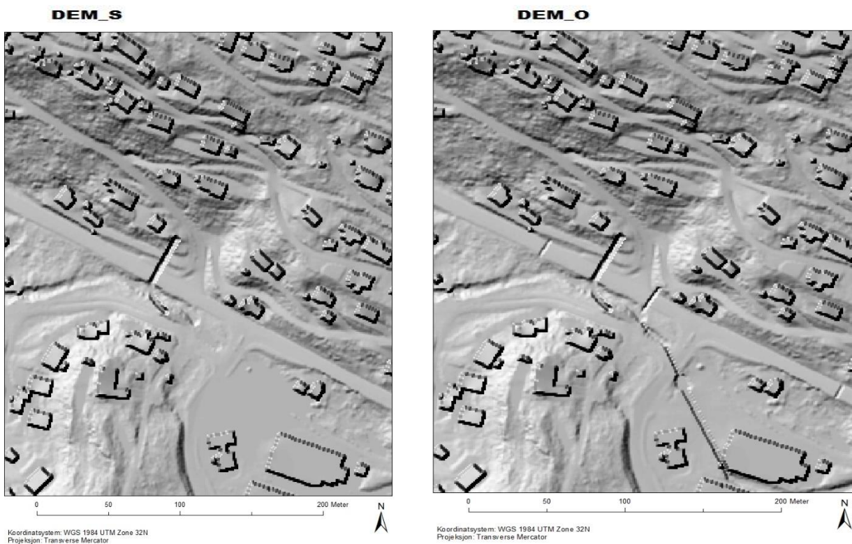
Figur 4.14: DEM_S med hevede bygninger (15 m) og senkede bruer (25 m) tilpasset scenarioet for stengte dreneringsveger og DEM_O med hevede bygninger (15 m), senkede bruer (25 m) og senkede stikkrenner og kulverter (10 m) tilpasset scenarioet for åpne dreneringsveger.
