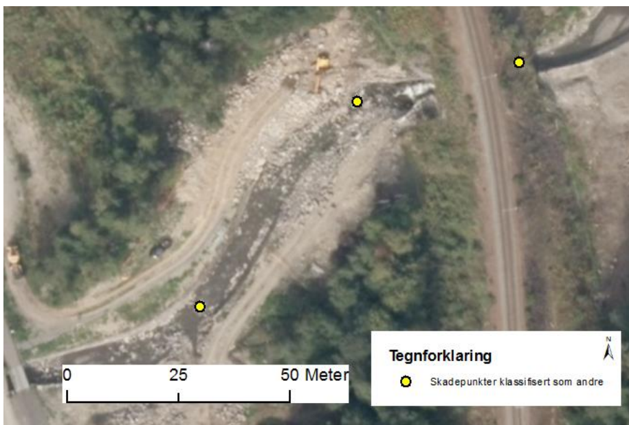
Figur 5.13: Skadepunkter langs nedre del av Årettaelva klassifisert som andre som følge av at blokkerte dreneringsveger oppstrøms leder vannet bort fra den naturlige vannveien.
