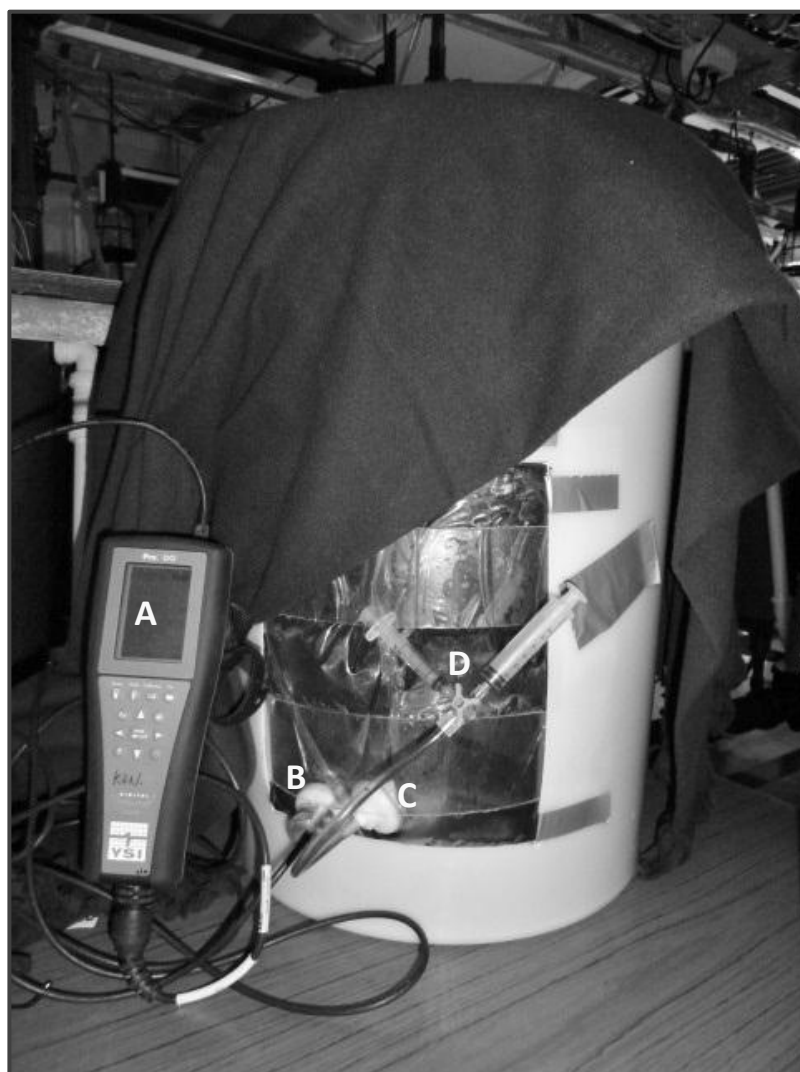
Figur 2.3: Oppsett for oksygenmålinger i forsøksenhet.
