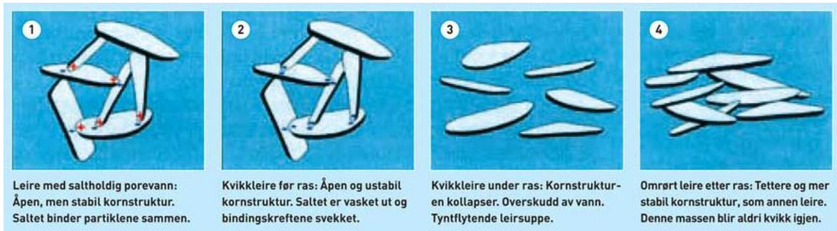
Figur 2.1: Kvikkleire, før, under og etter skred. Kilde: Reitan 2011.
