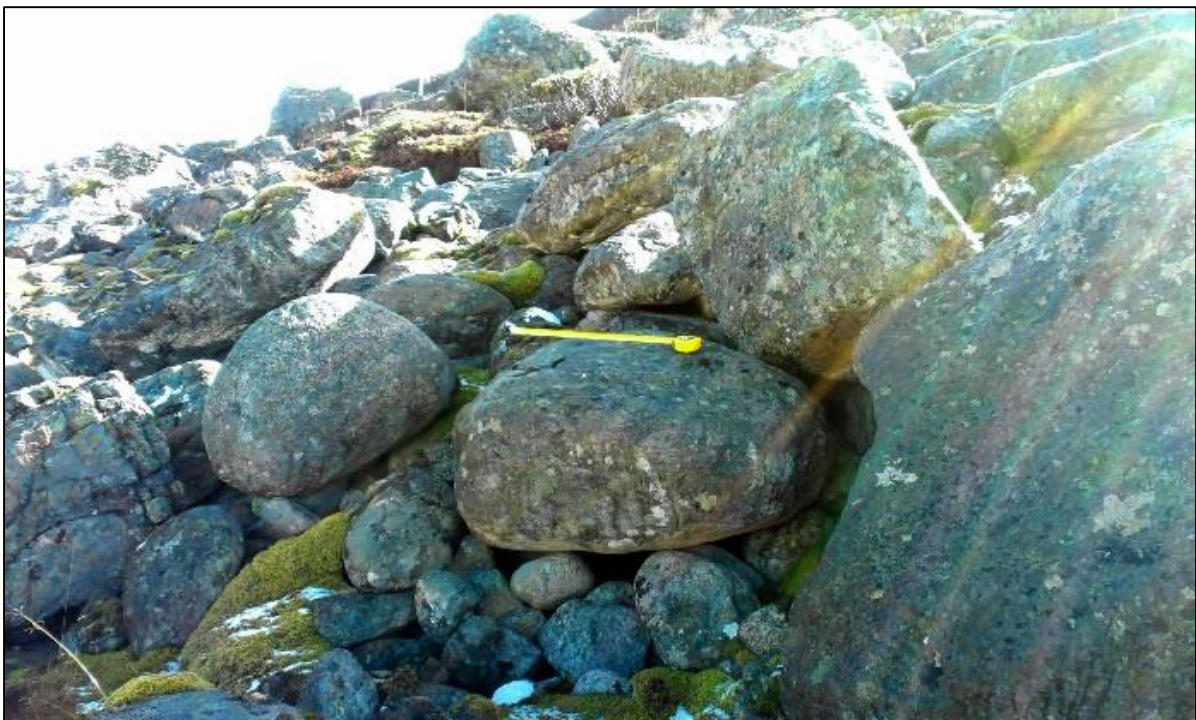
Figur 19 Partikkelstøttet struktur med finere partikler i hulrom under de grovere, ved foten av skråningen ved Vollvika-nord. Fine blokker, stein og grov grus er godt rundet. Målebånd 0,5m for skala (Foto: Line M. Ryg, 2013).
