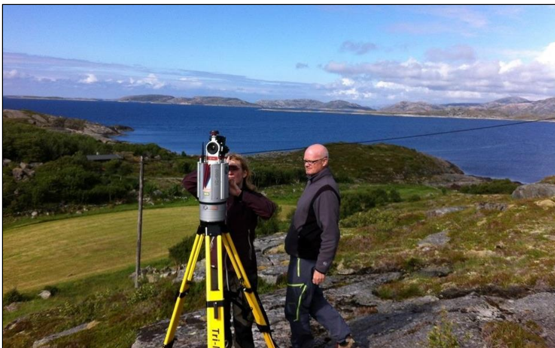
Figur 7 LiDAR-skannerens posisjon ved Barvika. Kanten av avsetningen som ble scannet vises til venstre. Et digitalt kamera er montert på LiDARen (foto: Ida Hennig, 2013).
