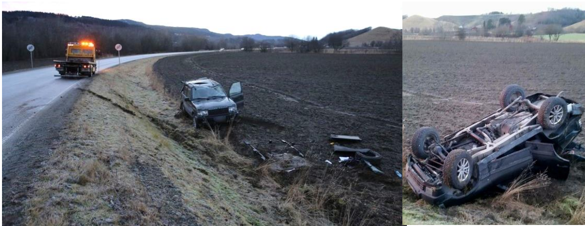
Figur 69: Viser utforkjøring på fv. 757 ved Vuku i Verdal kommune. Bilen har sklidd av vegen og gått rundt (bilde til høyre viser dette). Her mangler det rekkverk. Sideterrenget er av en slik beskaffenhet at det kunne ha vært bakke-planert med helning < 1:4 . (Kilde: Trønderavisa).
