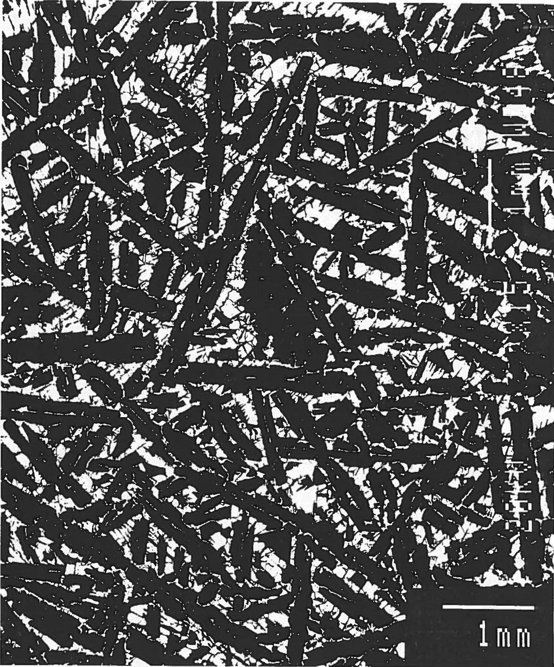
Figur 5.7 Strukturilde av 75% ferrosilium utstøpt i karusell og vannkjølt. Prøve 10.1. Referer vedlagt skala.
