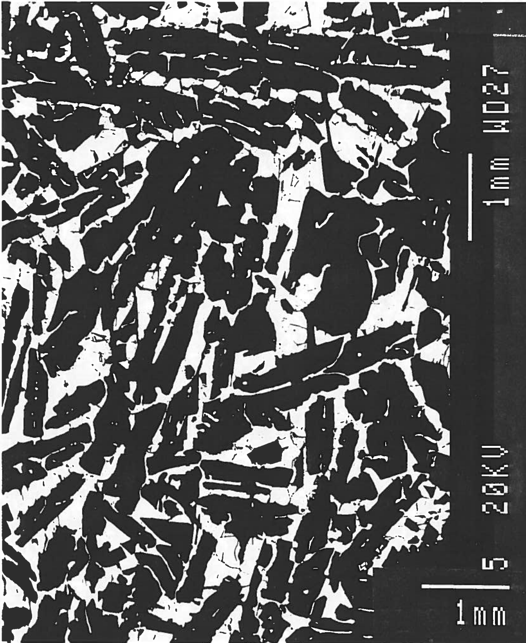
Figur 5.8 Strukturbilde av 75% ferrosilium utstøpt i finstoffseng. Prøve 3.1. Referer vedlagt skala.
