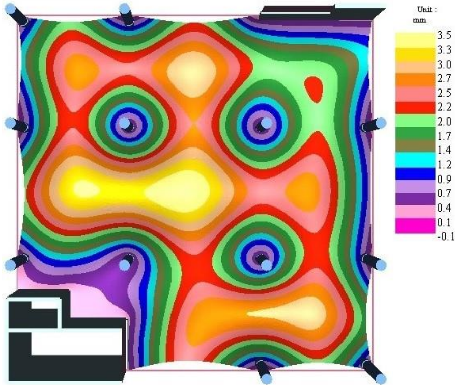
Figur 6-19 Nedbøyning ifra ADAPT for Søndre blokk
