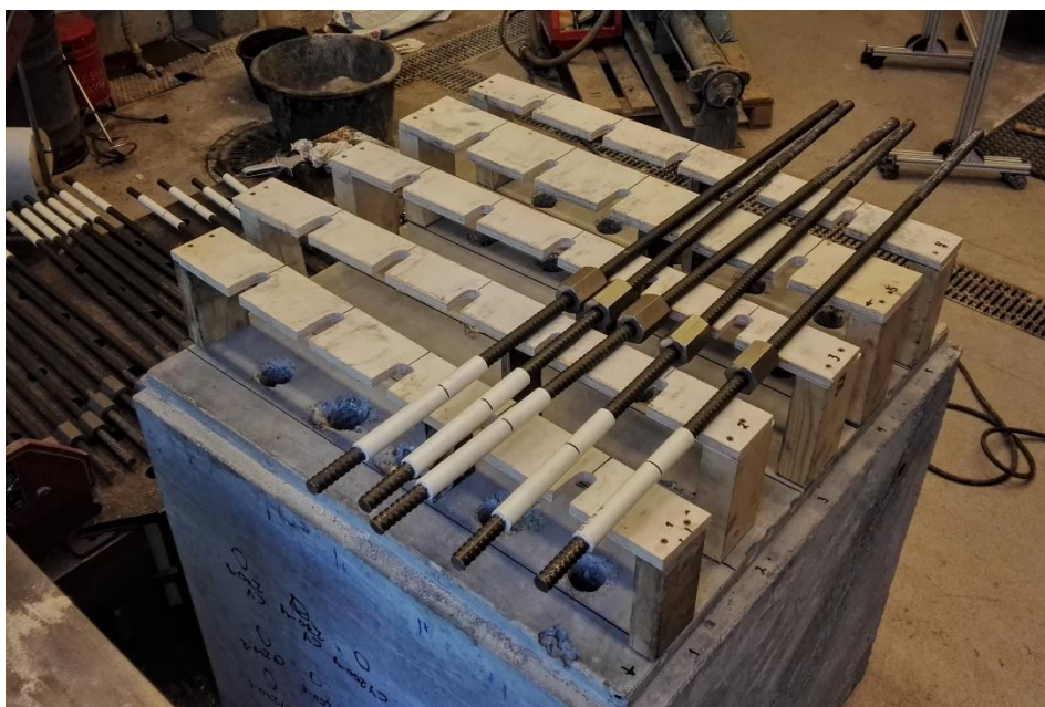
Figur 3.6: Stag og støtter klare før gysing
