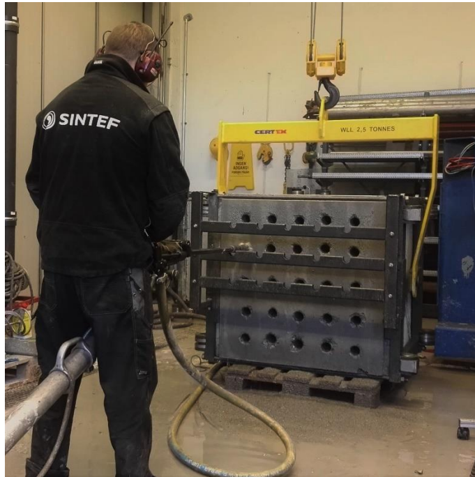
Figur 3.5: Bilde fra boringen av nye hull i testblokk
