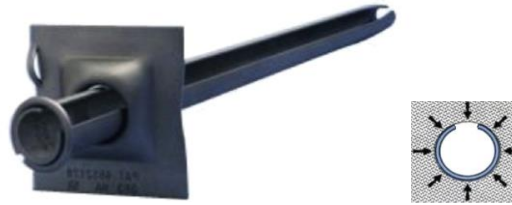
Figur 2.5: Friksjonsbolt, i form av en split set bolt. Illustrasjon hentet fra (Li, et al., 2013)
