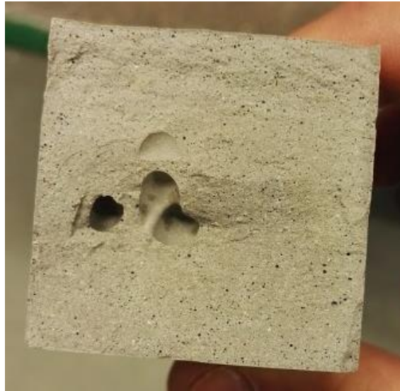
Figur 4.34: Prismeprøve med luftbobler
