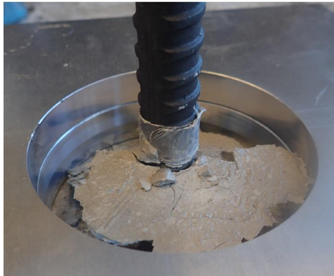
Figur 3.2: Aluminiumsplater med konusbrudd i mørtel etter testing, Hentet fra (Behrens, 2016)
