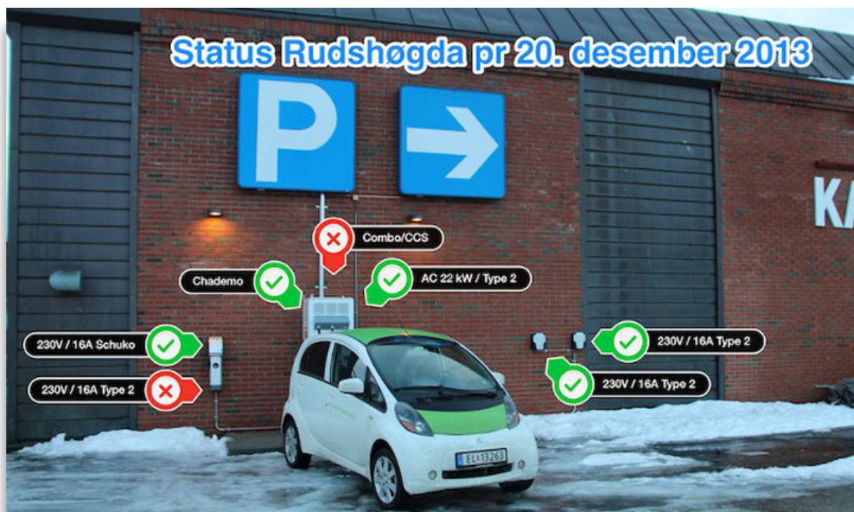
Figur 3: Hurtiglading representerer et stort utvalg av ladestandarder og effekter. Her ser vi en Mitsubishi i-MiEV som står på en hurtigladestasjon.,foto:Norsk Elbilforening
