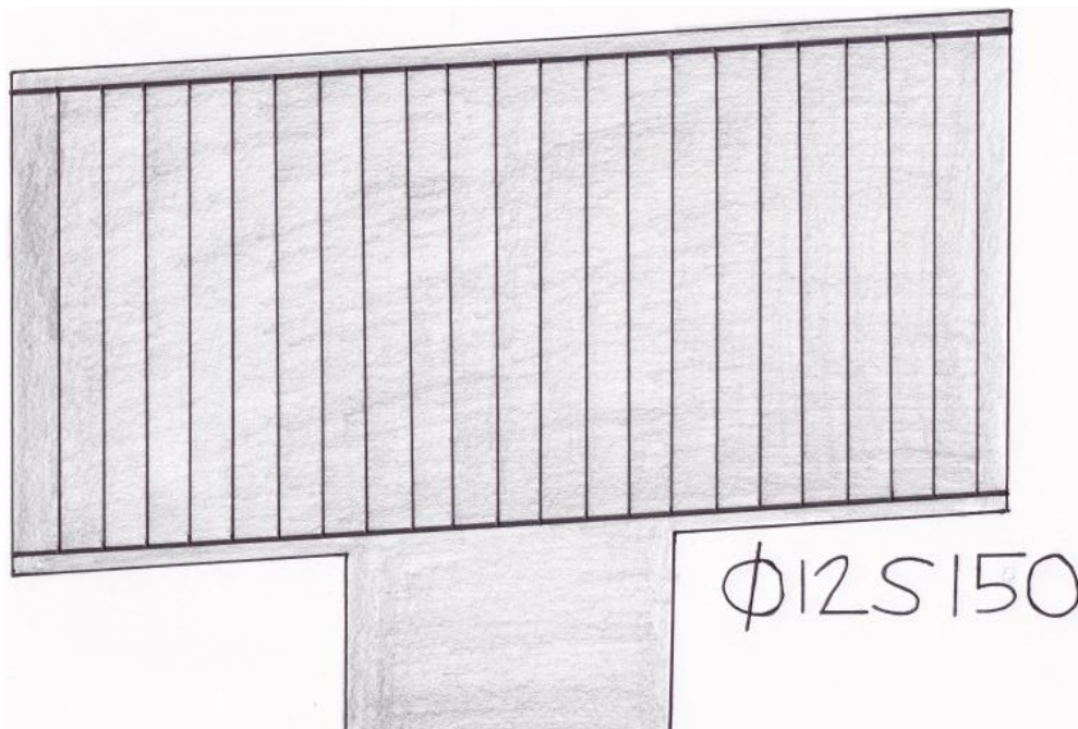
Figur 7.7 Tegningen illustrer utførelsen av skjærarmeringen i det kritiske snittet som består av vertikale lukkede bøylor med dimensjon \phi = 12 \text{ mm} og senteravstand s = 150 \text{ mm} .
