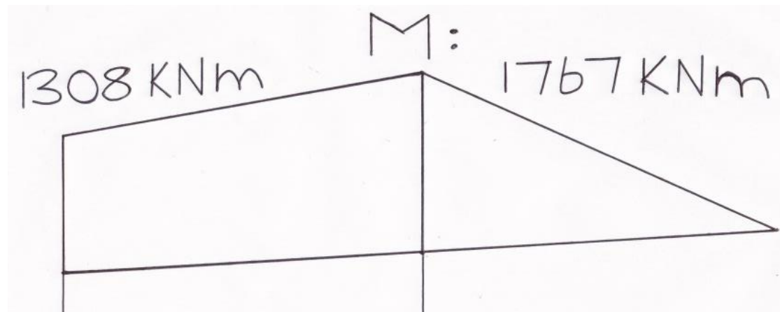
Figur 6.13 Momentdiagram for temperaturdifferansen \Delta T_{M,cool} som bidrar mest til den ugunstige termiske lastvirkningen.
