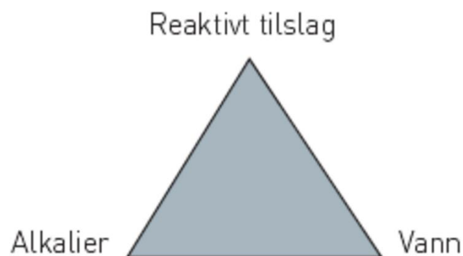
Figur 11.1 Reaksjonstrekanten viser de tre betingelsene som må være oppfylt for at en alkalireaksjon skal finne sted.
