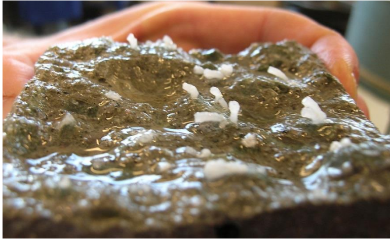
Figur 11.2 Bildet viser alkaligelen som oppstår i en alkalireaksjon. Bildet er av et prøvestykke hvor alkalireaksjonen har blitt akselerert i laboratorieforsøk og alkaligelen tytter ut som ormer.
