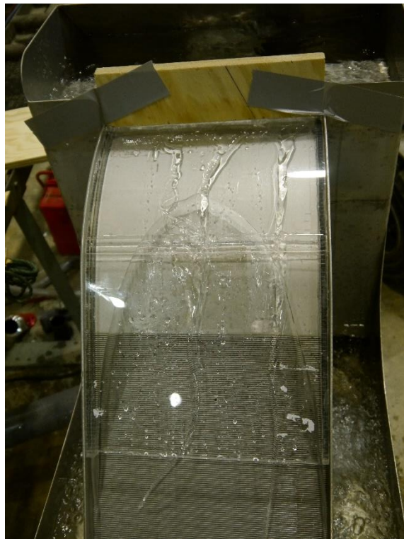
Figur 11 Her er det øvre magasinet hevet for å for ekstra stor overtopping. Dette for å sørge for at snorkelen blir til en hevert.
