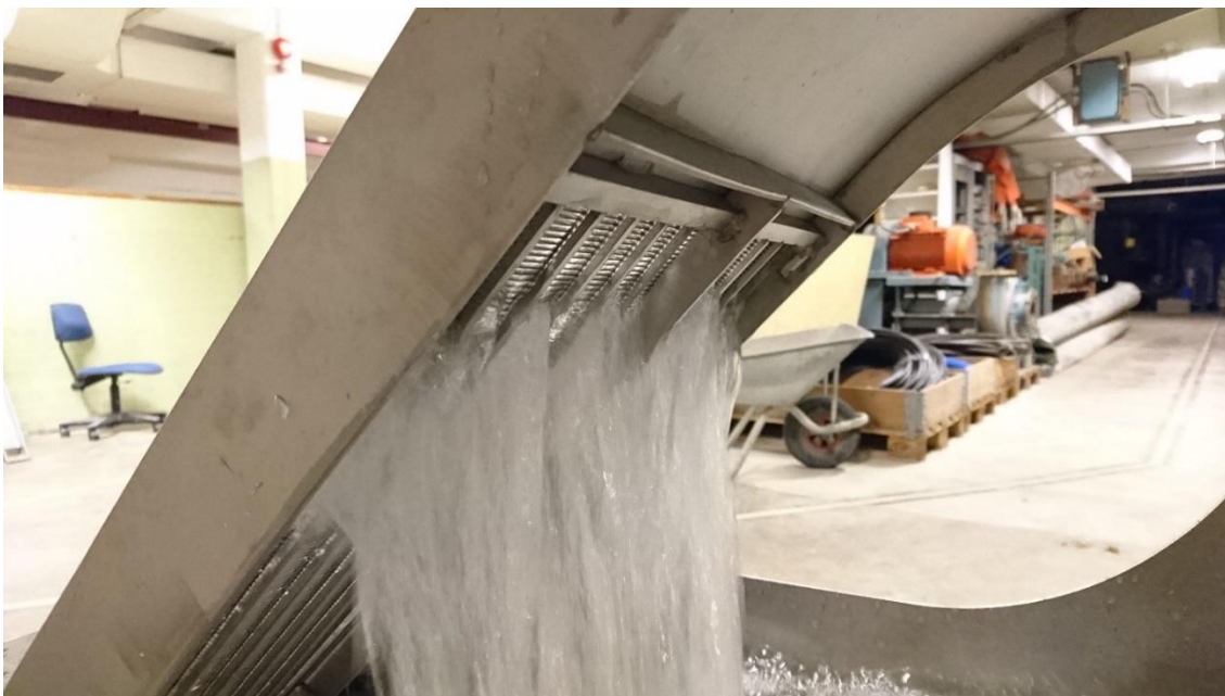
Figur 13 Undersiden av Coandarista når den fungerer som hevert. Vanligvis ville vannet blitt tatt inn fra de første spaltene av.
