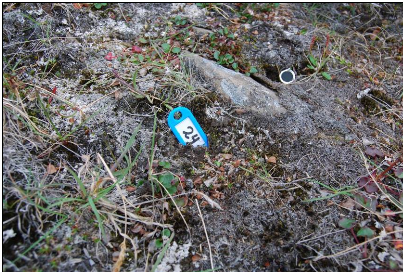
Figur 5. Merket datalogger etter utlegging. Nummer på dataloggeren følger nummer på analyseruta. Foto: O.E. Stabbetorp.
