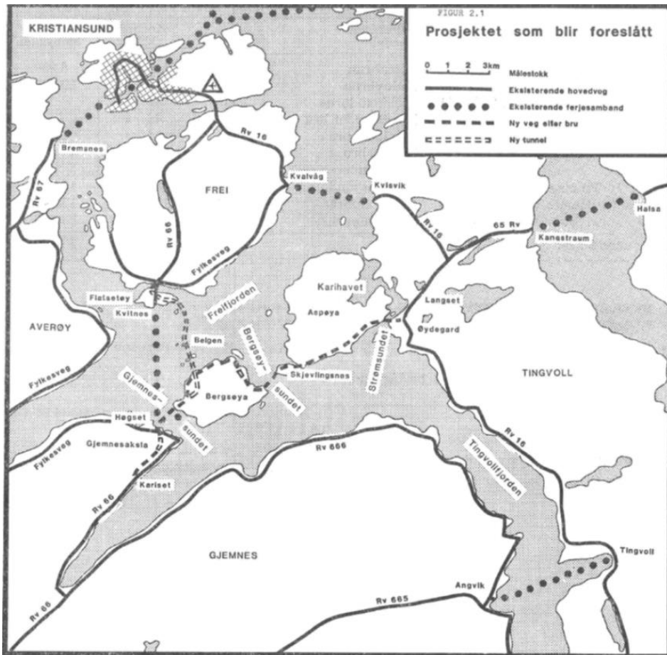
Figur 2-3: Planområdet for KRIFAST (vegen ble til slutt lagt på sørsiden av Bergsøya med flytebru over Bergsøysundet, tre ferjesamband ble lagt ned)
