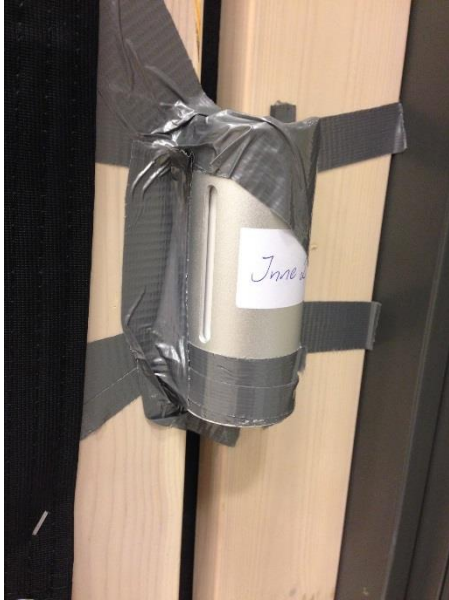
Figur 6.2.4.2 Modul 2 festet til veggen i 1,2 m høyde i Heimdalshallen.
