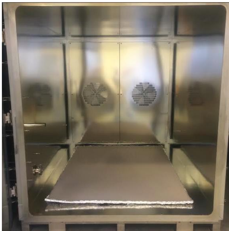
Figur 6.1.6.3 Plassering av kunstdekke i forsøkskammer.
