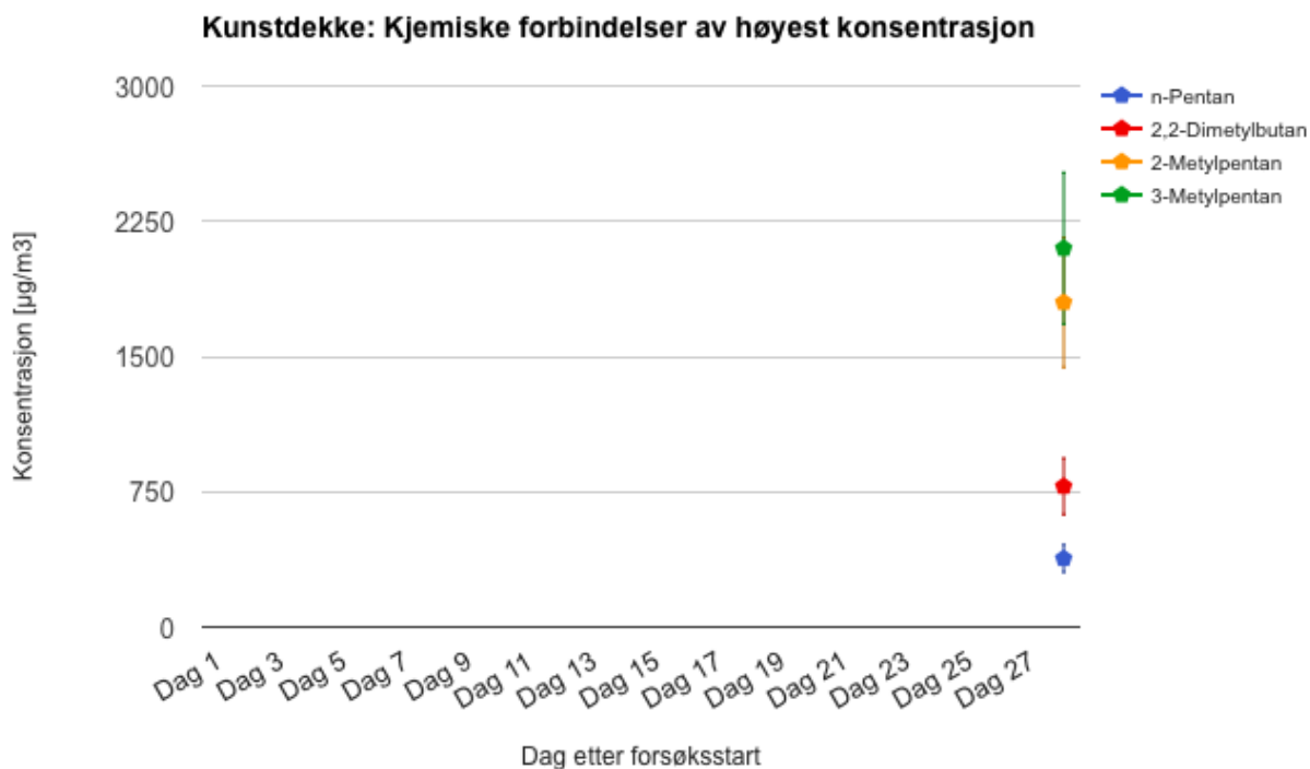
Figur 7.2.3.4 Emisjon av de fire individuelle VOC med høyest konsentrasjon [ \mu\text{g}/\text{m}^3 ] ved dag 28 etter forsøksstart fra kunstdekke med en måleusikkerhet på \pm 20\% .
