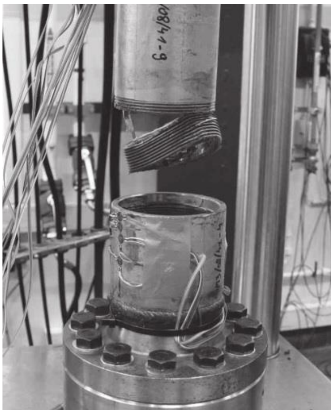
Figur 72. Fullskala utmattningstest utført på 4.5" API stigerør i Wittenberghe [3]
