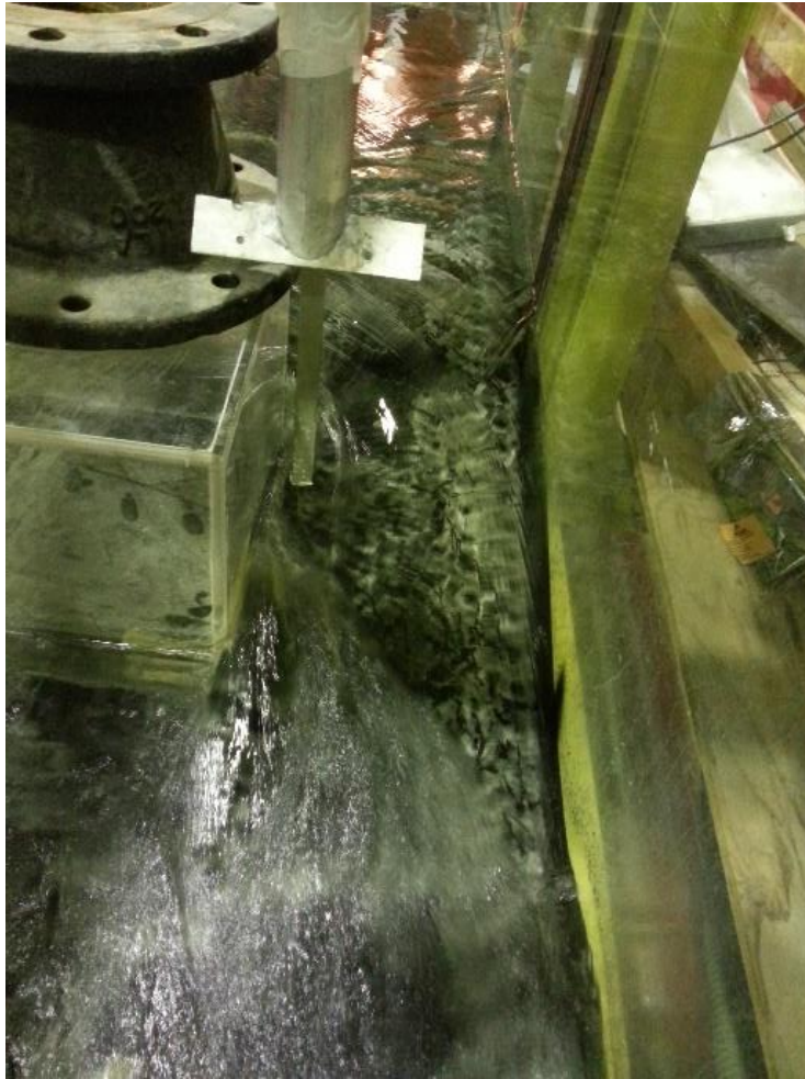
Figur 4: Måling av vannhøyde i tverrsnitt 3 for situasjon 2.
