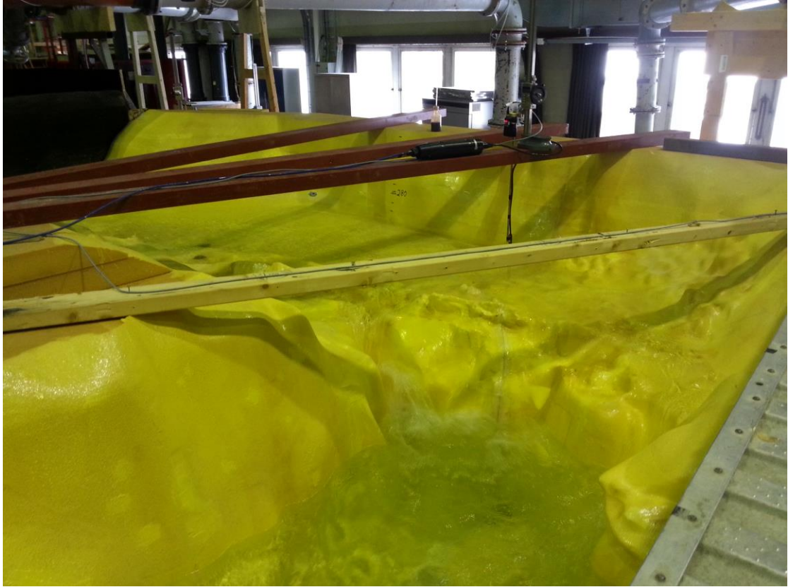
Figur 11: Fysisk modell av Eggafossen med vannføring på 6 l/s. Området i midten av modellen med hovedfossen til venstre i elveleiet.
