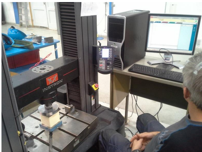
Figur 67:Kjøring av terning 100 x 100 mm i prøvemaskin på materialteknisk laboratorium NTNU
