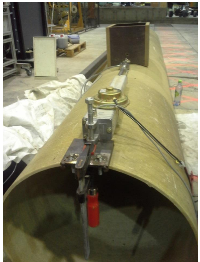
Figur 46: t.v forsøk er gjennomført, bilde tatt før demontering. Legg merke til lodd og det tynne laget med finmasser som ligger igjen på røret. t.h:sylinder og kasse montert på GRP-rør.
