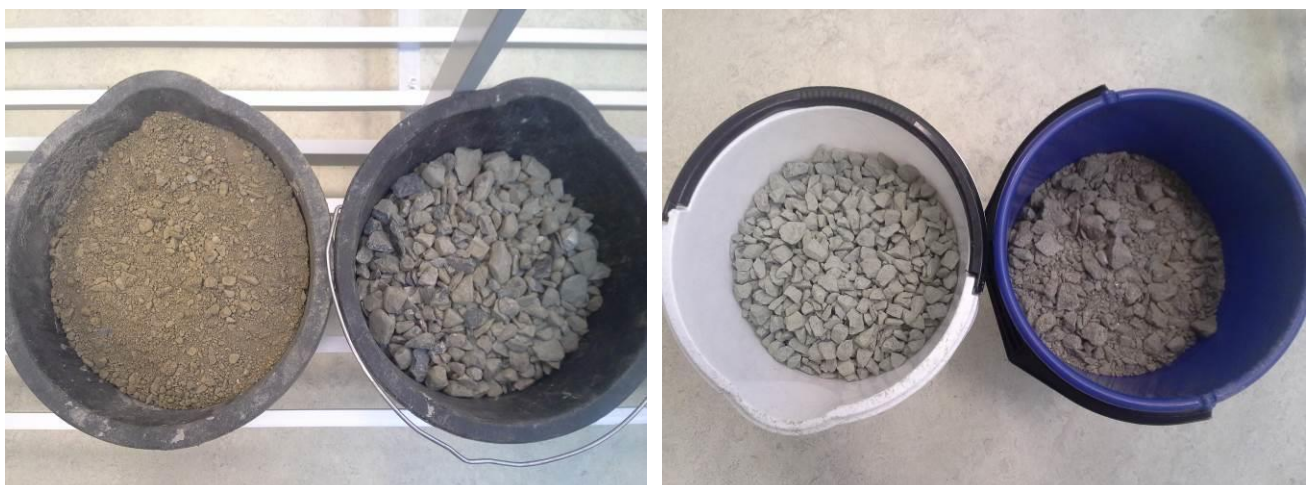
Figur 11: Materialprøver hentet fra rørgate på kraftverk under bygging. Fra venstre: Støttefylling Væla, bæresone Væla, bæresone Sundli, omfylling Sundli.
