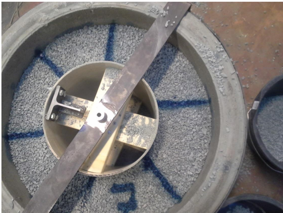
Figur 81: Oppsett for GRP-rør i samme testrigg
