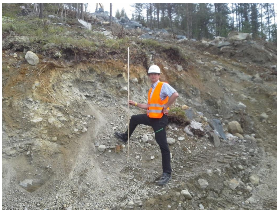
Figur 20: Grus/Morenerygger i grøftetraseen ca 200 meter opp for Tverråne kraftverk. Personen holder en tommestokk på 2,0 m. Masseprøve M1 er hentet like ved. (Foto: Tor Oxhøvd Svalesen)
