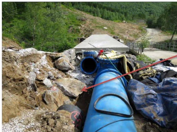
Figur 21 T-stykket har bøyd seg opp til en avvinkling på 9,0 grader etter bruddet og et helt rørstykke på 2,8 m mangler. Kilde: Norconsult/Norsk Grønnkraft AS
