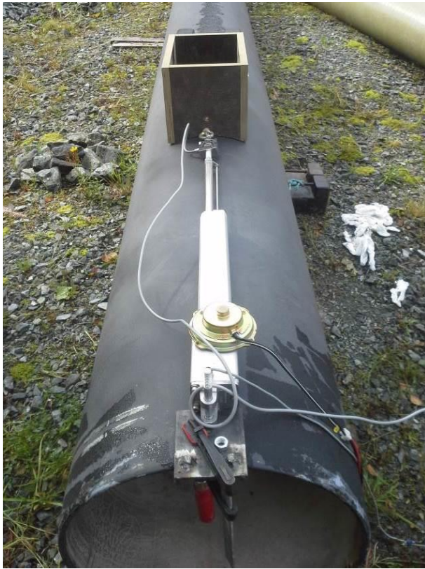
Figur 44: sylinder og kasse montert på sink/bitumenrør
