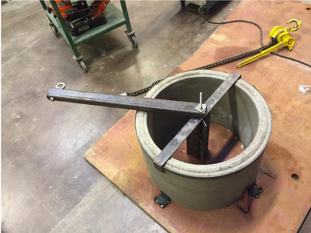
Figur 80: Oversikt over forsøksoppsett. Jekken festes i øyebolten på armen som påfører moment på vingene på sylindere nede i betongringen. Når armen beveges vil prøvestykket rotere. Fastsveising av betongringen synes nede til høyre.
