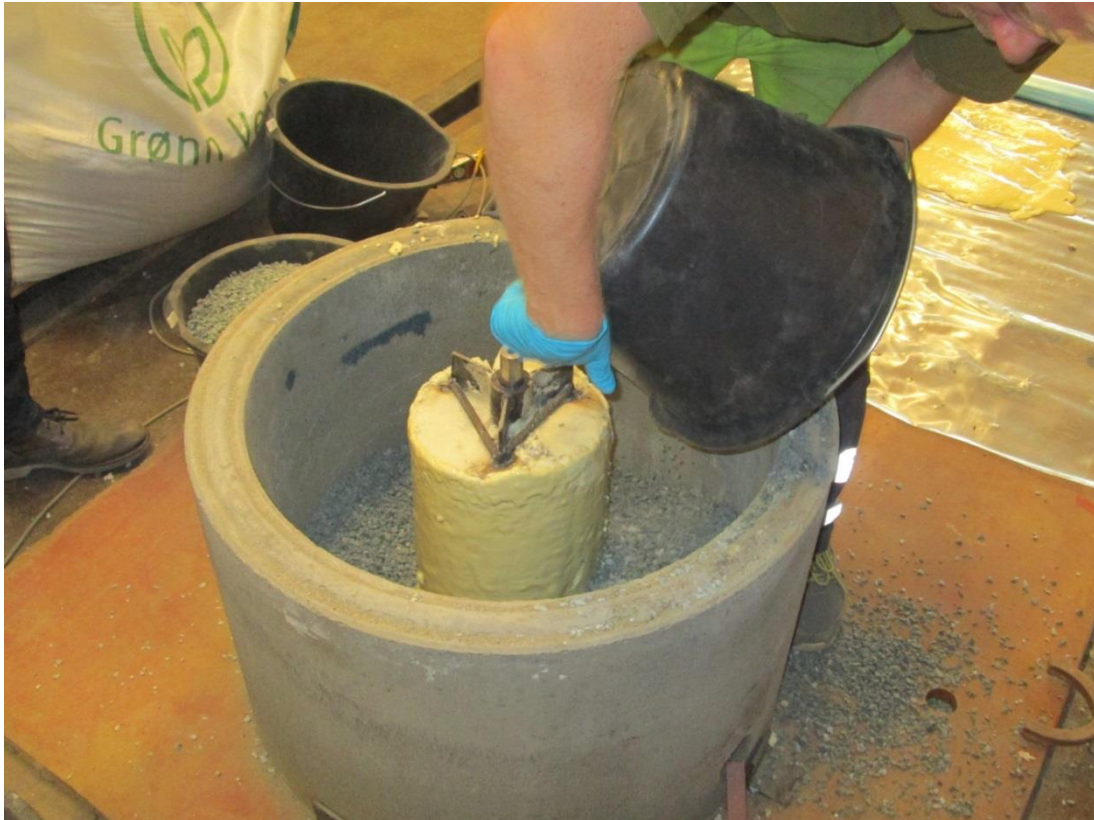
Figur 78: Montering av PU-sylinder og omfylling med masser. Ureagert PU synes som gult flytende materiale på kjernen.
