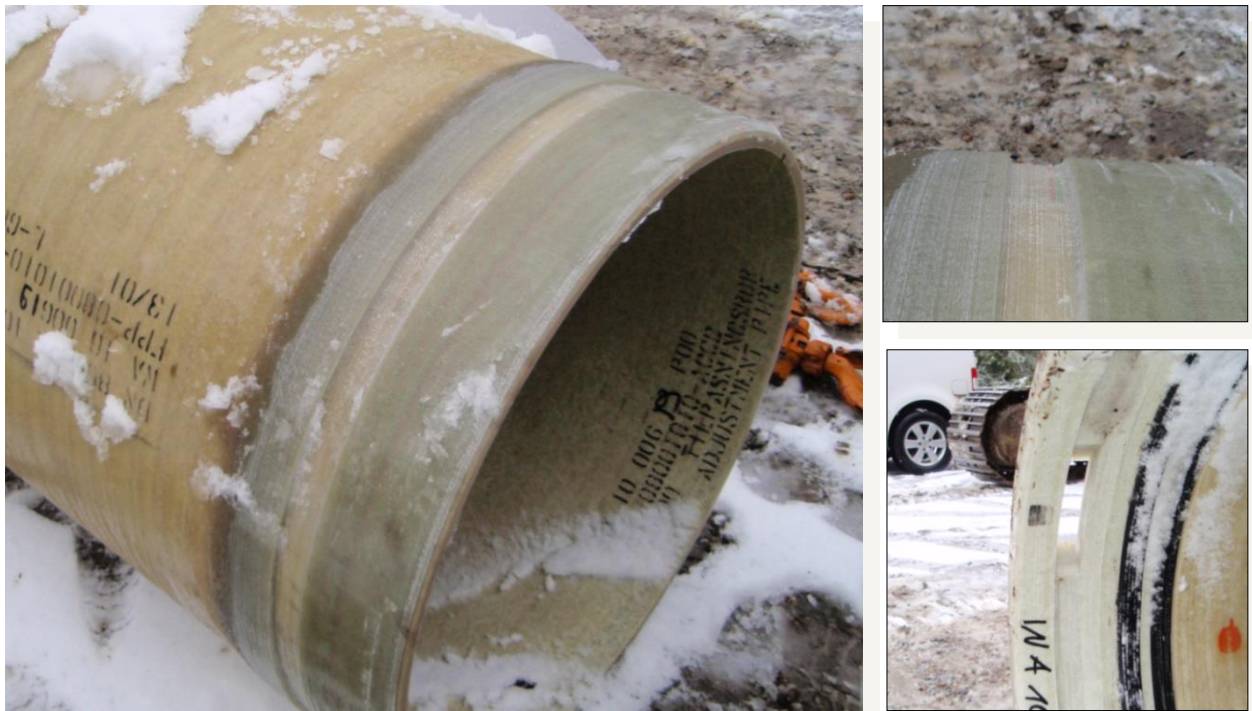
Figur 4: Venstre: GRP-rør med ekstra tykk ende og freset spor til låsing, øverst h.: nærbilde av låsespor, nede h.: muffe med utfresa spor til låsering og hull for entring av ring inn i sporet (Brødrene Dahl)
