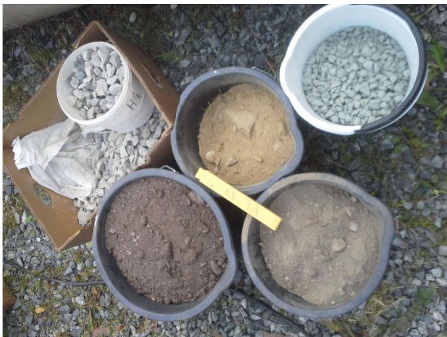
Figur 33: De fem masseprøvene brukt på GRP og duktile rør. Øverst fra venstre: M7, M1, og M6. Nederst fra venstre: M5 og M4
