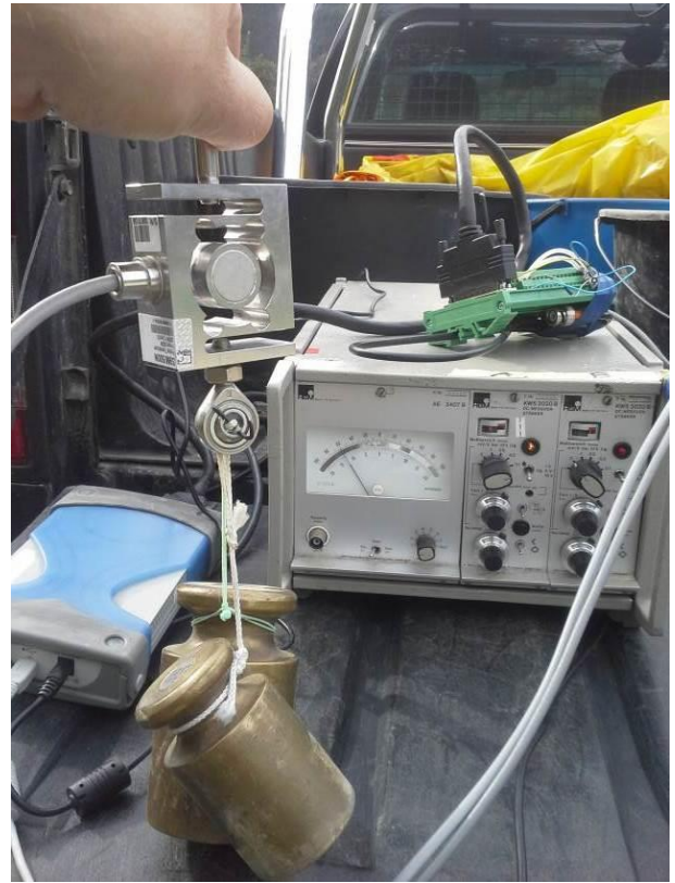
Figur 43: Loggeutstyret, lastcelle og kalibrering med 1,0 og 2,0 kg lodd
