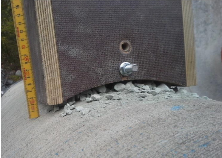
Figur 56: Oppløft av kasse på grunn av momentkrefter fra trekkraften i sylindren
