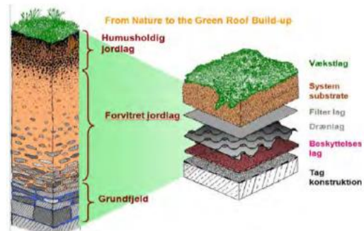
Figur 5: Oppbygning av grønne tak sammenlignet med naturen (Noreng, et al., 2012)
