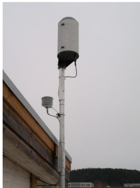
Figur 17: Bilde av nedbør-, temperatur- og relativ luftfuktighetsmålere
