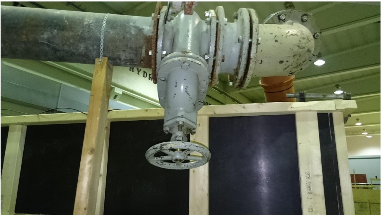
FIGUR 28: SPJELDVENTIL FOR Å JUSTERE VANNMENGDE INN I MODELLEN
