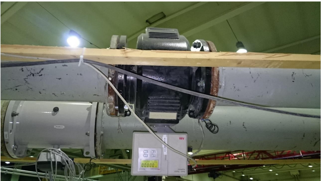
FIGUR 30: MÅLING AV VANNMENGE INN I MODELLEN
