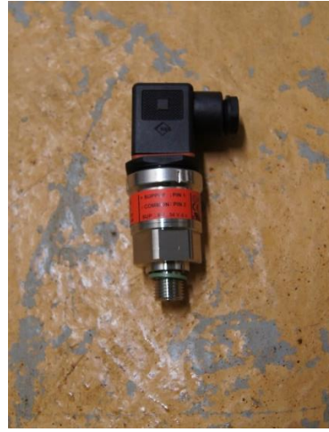
Figur 43 Piezo resistiv trykkmåler, Danfoss Type MBS 3250 (Foto VN)
