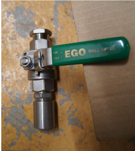
Figur 42 Kuleventil som brukt på Brattørbrua pumpestasjon (Foto VN)
