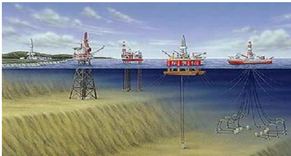
(Bildet illustrerer de ulike typer faste- og mobile plattformer – www.eoearth.org )
