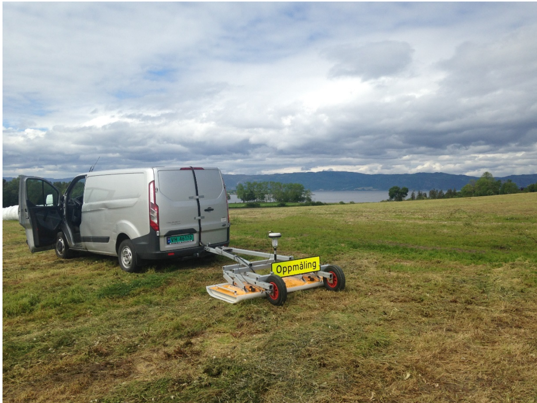
Figur 3: Datainnsamling i praksis. Georadarutstyret består av et antennesystem montert på et tilhengerfeste, som så blir trukket bak et kjøretøy med tilhengerfeste. Dette bildet er fra et prosjekt på gården Rygg på Frosta, Nord-Trøndelag. Foto: Arne Anderson Stamnes, NTNU Vitenskapsmuseet. Da61126
