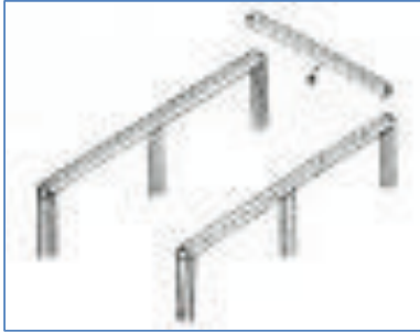
Figur 6 Prinsippet bak stavlinekonstruksjoner (til venstre) og grindverkskonstruksjoner (til høyre). (Hentet fra http://www1.uis.no/fag/Learningspace_kurs/guide/Tidslinjer/Arkitekturhistorie/tekstsider/antikken/norsk.htm .)
