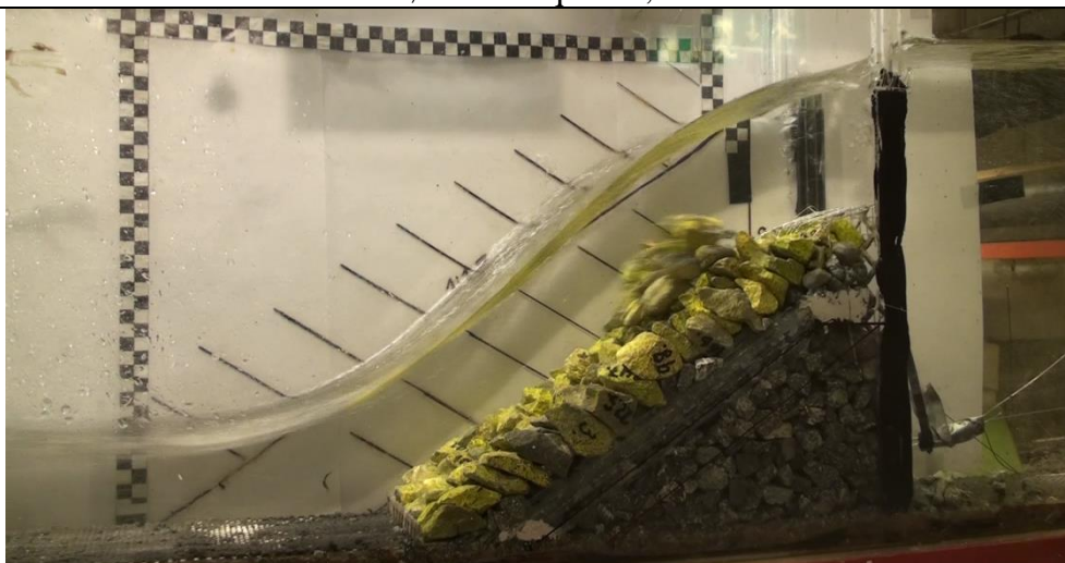
Ved brudd. Øvre del av plastring lengst vekk fra kameraet går ut. Bruddet begynner i topp, rett under kronevernet og risten. q= 124,9 \text{ l/s/m}
