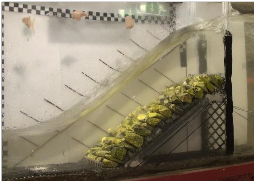
Figur 3.17: Videokamera filmer fra siden, og plassert med litt vinkling for å filme større del av skråningsvern. Velegnet til å definere bruddårsak k
