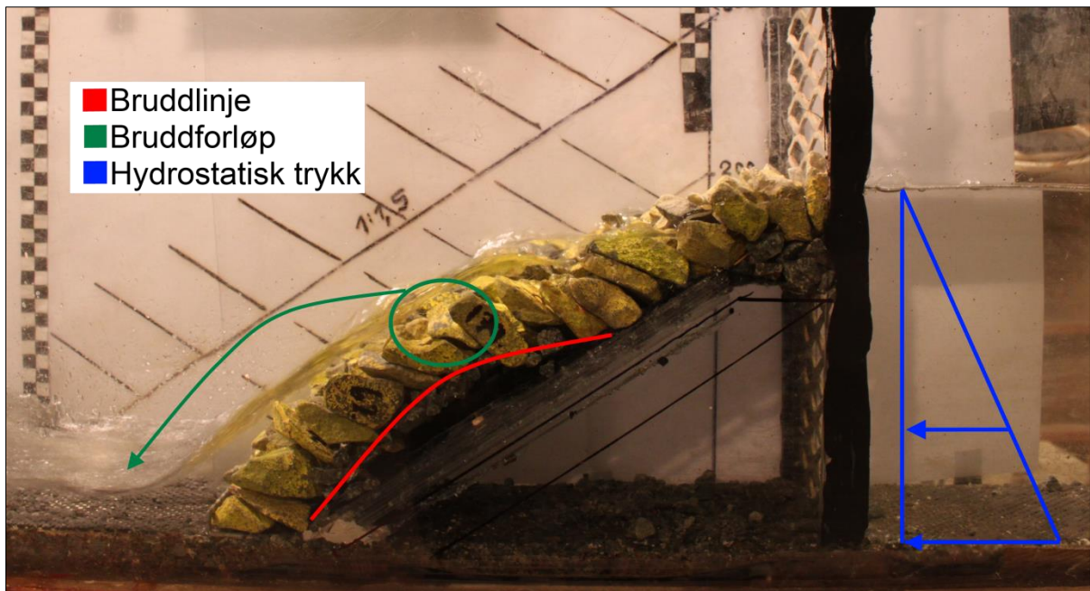
Figur 4.9: Bruddforløp forsøk 2_1. Gradvis utvikling av bruddet ved gjennomstrømning
