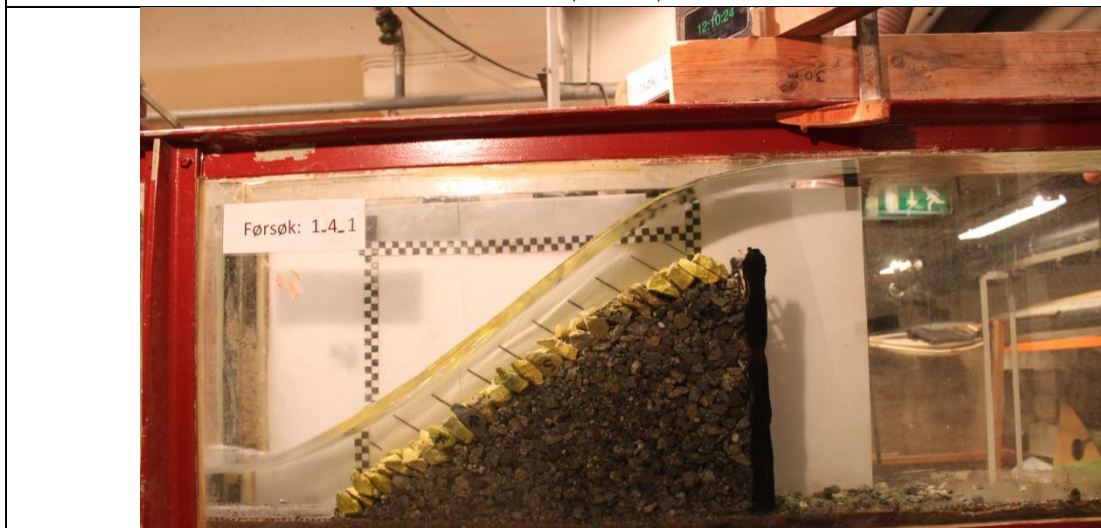
Dammen utsatt for q = 118,1 l/s/m. To stein bakerst i kronevern har løsnet, på grunn av setninger i dammen.
