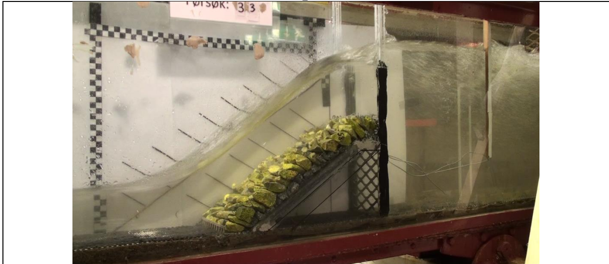
Før uttrekking av plastringstein
