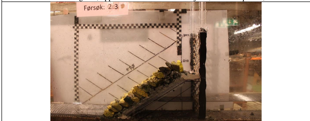
Etter forsøk. Hele kronvern er røket, som et resultat at plastringssteinene har satt seg, og innspenningen til kronevernet dermed forsvinner.
