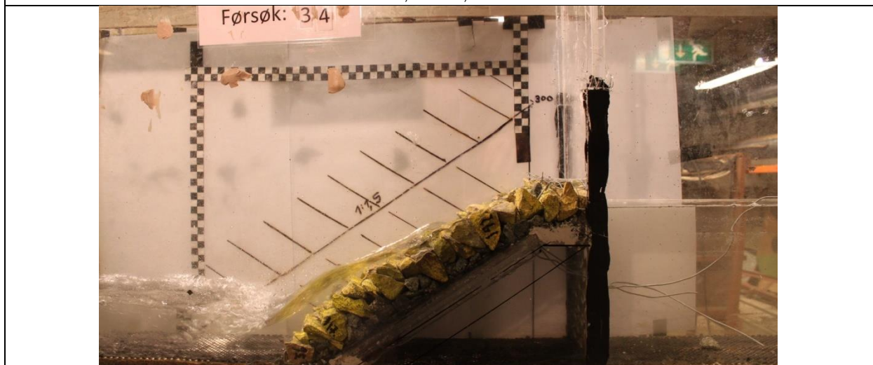
Stabil vannføring. Neste økning fører til globalt brudd, q= 26,1 l/s/m.
