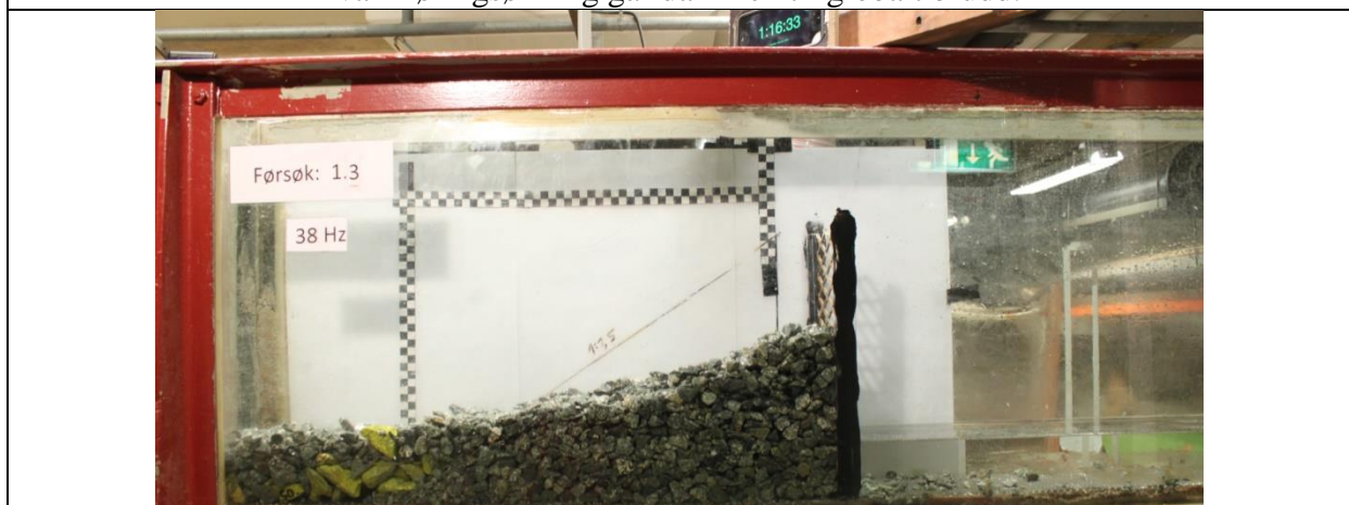
Etter forsøk. Dammen har gått til globalt brudd.
