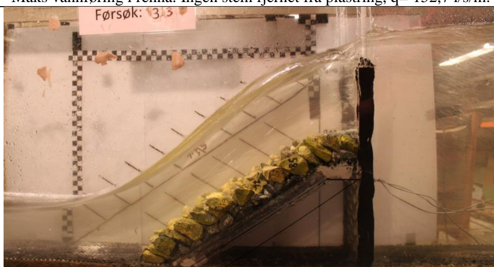
Maks vannføring i renna. 11 steiner fjernet (av totalt 133), og stabil situasjon. q = 152,7 l/s/m
