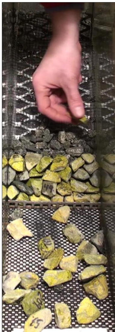
Figur 3.11: Støttefylling økes gradvis med plastring
