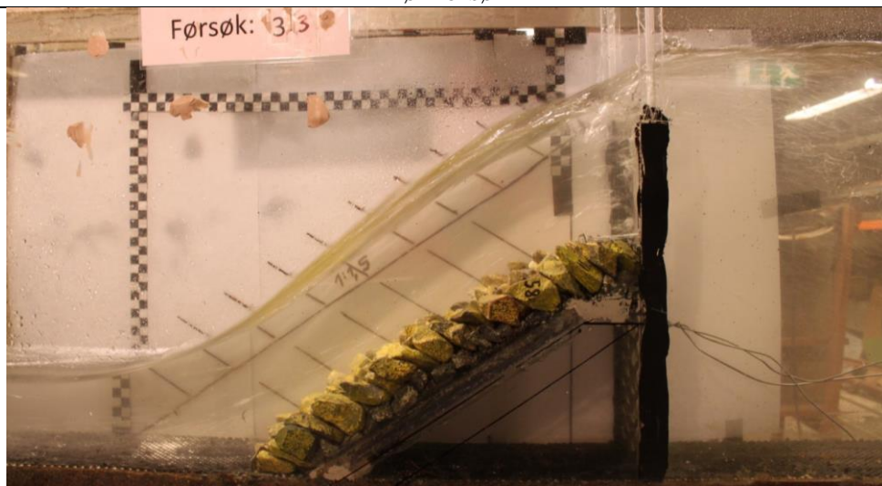
Maks vannføring i renna. Ingen stein fjernet fra plastring, q = 152,7 l/s/m.
