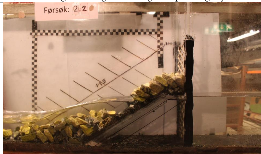
Etter brudd. Hele skråningsvernet er røket. Bildet viser at forsøket må kjøres med konstant vannføring etter brudd, for å kunne bestemme bruddvannføring.
