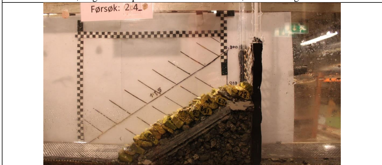
Etter forsøk. Lite forandring i plastring.
