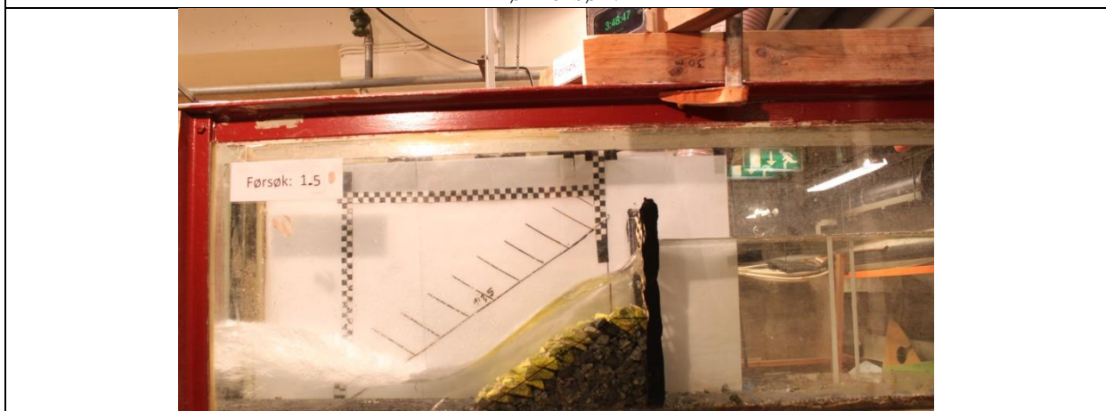
Dammen utsatt for q = 64,2 l/s/m. To stein bakerst i kronevern har løsnet, på grunn av setninger i dammen.
