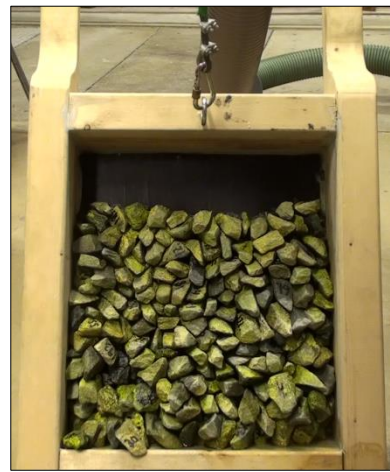
Figur 3.15: Plastring sklir på finérplaten, og buler ut i nedre del
