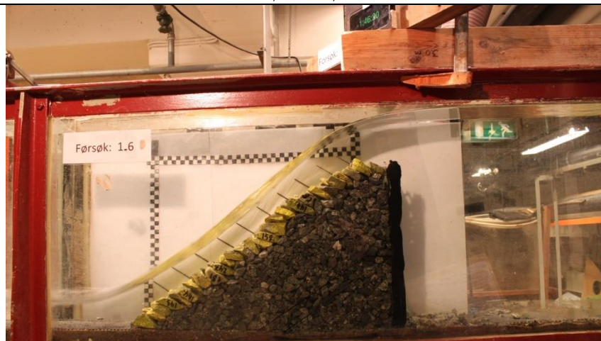
Kronevernet presset litt ut. Tre steiner løsnet i kronevern ved rist. q = 90,1 l/s/m.
