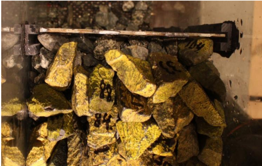
Figur 4.6: Forsøk 1_6 plastret opp etter brudd med samme steiner. Bildet tatt ovenfra på kronevernet, oppstrøms rist sees øverst i bildet t
