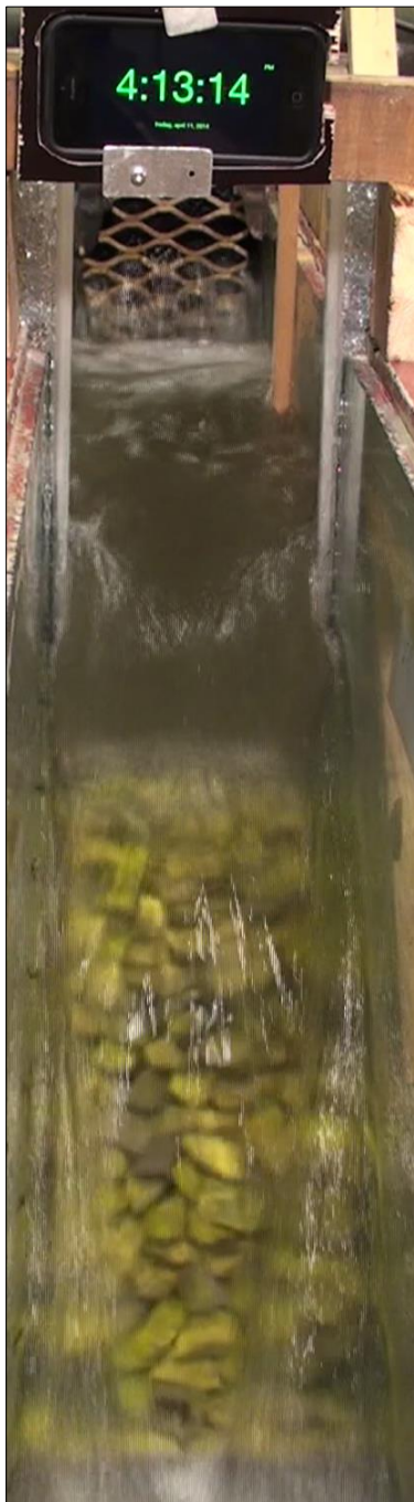
Figur 3.16: Videokamera filmer normalt på skråningsvernet. Vanskelig å dokumentere bruddårsak
