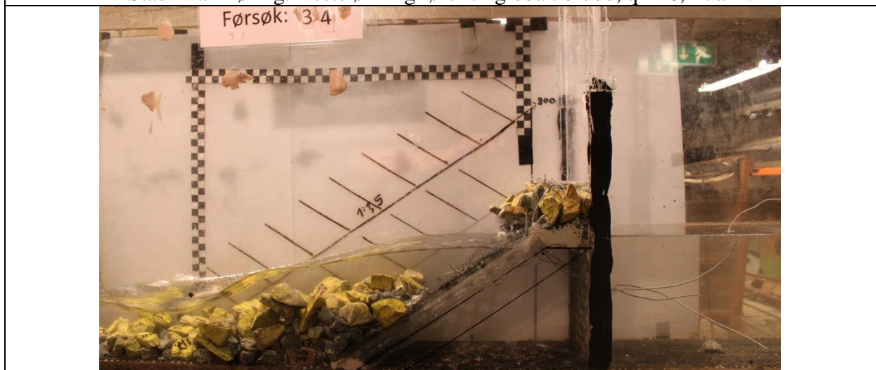
Stabil vannføring etter globalt brudd, q= 30,4 l/s/m
