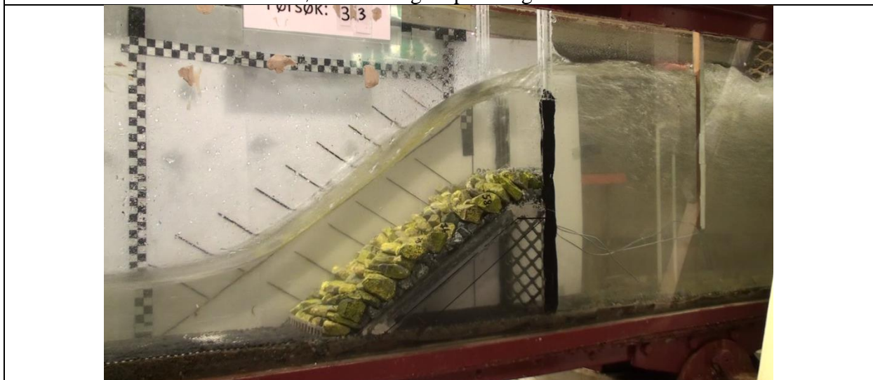
Ni stein fjernet fra plastring. q = 152,7 l/s/m.
