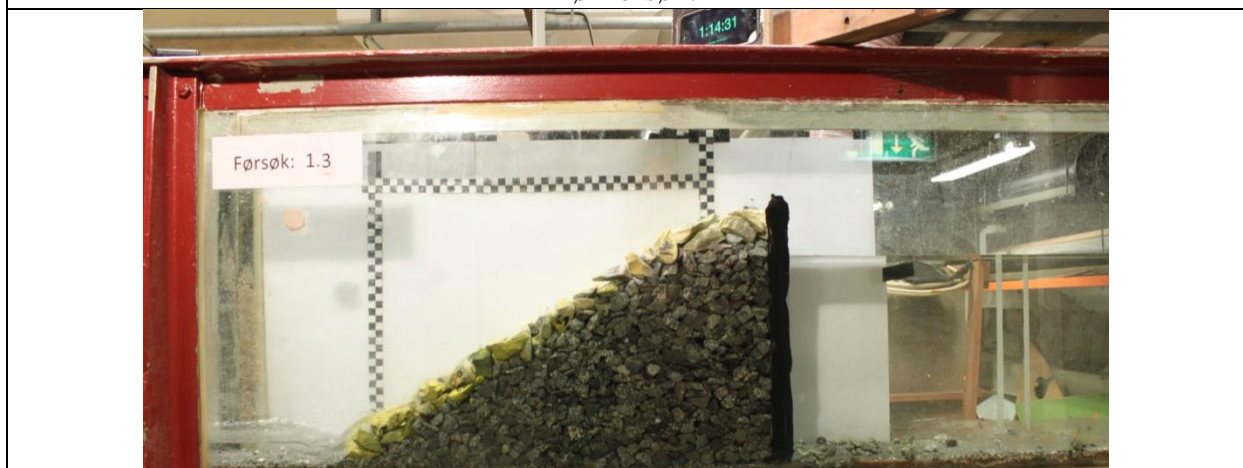
Dammen utsatt for q=9,2 l/s/m. Ved denne situasjonen står dammen stabilt, og ved neste vannføringsøkning går dammen til globalt brudd.
