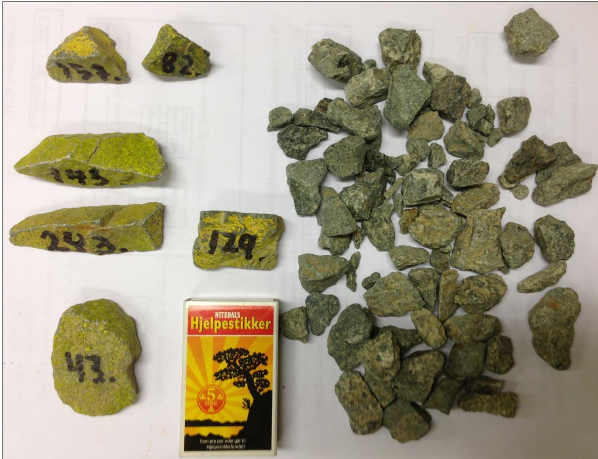
Figur 3.5: Plastringsstein i forskjellige størrelser til skråningsvern og støttefylling.
