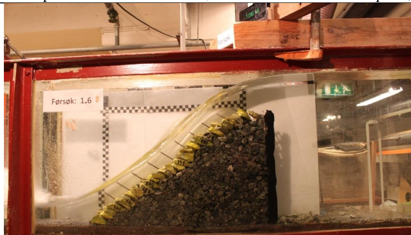
Kronevernet presset betydelig ut. Flere ytterligere to steiner fra bak ved risten er revet med. Brudd kommer etter neste økning. q = 114,7 l/s/m
