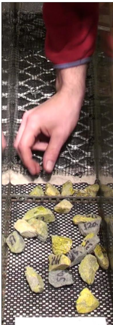
Figur 3.10: Tåstein legges før støttefylling
