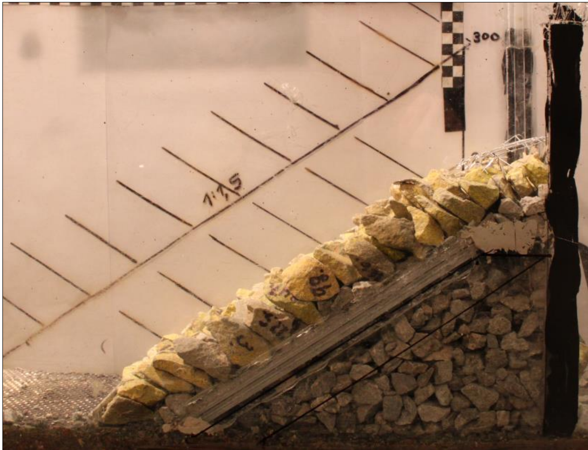
Figur 3.9: Gjennomstrømning og overtopping. Fastlåst kronevern, fra forsøksserie 3
