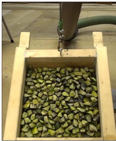
Figur 3.14: Plastring utsatt for økende helning
