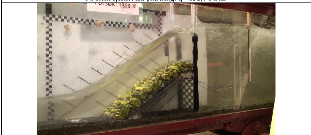
11 stein fjernet fra plastring. Plastringen har satt seg, men er fremdeles stabil. q = 152,7 l/s/m
