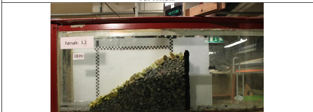
Dammen utsatt for stabil vannføring. Neste vannføringsøkning resulterer i globalt brudd. q=6,2 l/s/m
