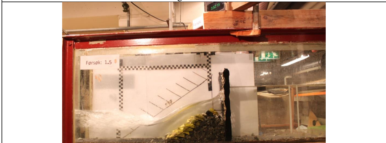
Etter brudd. Store deler av krone røket. q = 74 l/s/m.
