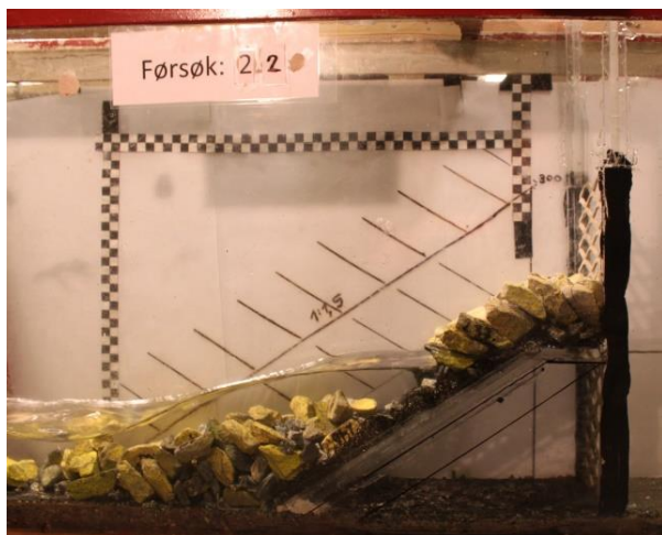
Figur 5.6: 2_2 rett etter brudd. Utsatt for gjennomstrømning
