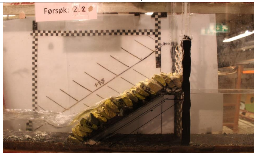
Stabil situasjon før brudd. Ingen setning eller bevegelse i plastring skjedd enda. q=22,1 l/s/m.
