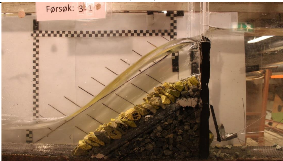
Situasjon hvor øvre halvdel av plastring er presset ut og ned. q = 123,2 l/s/m.
