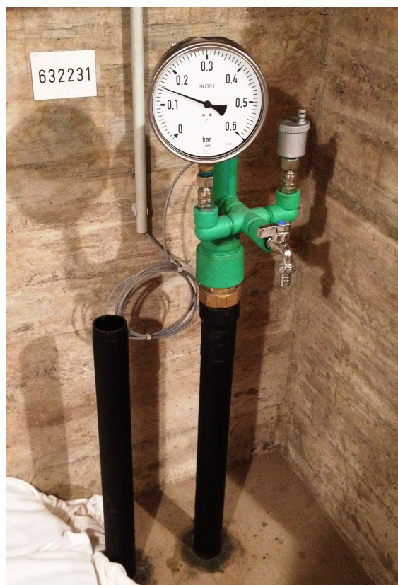
Figur 4.7: Toppen av to standrør, et med og et uten trykkmåler
