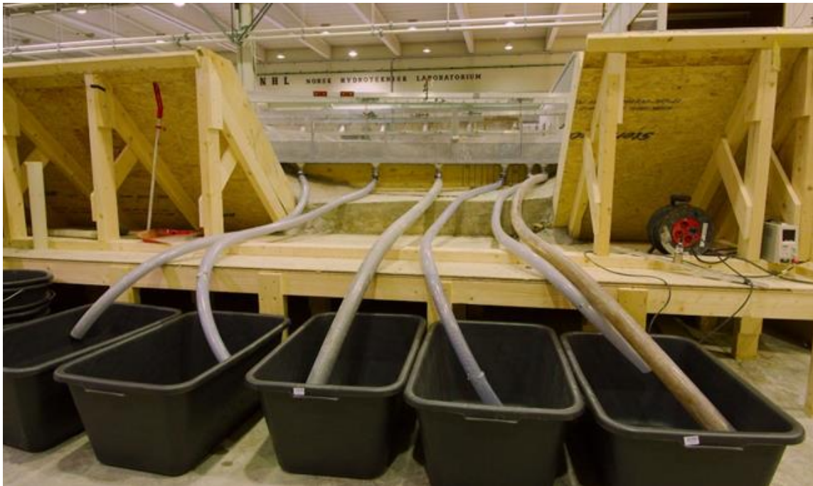
Figur 3-7: Kammer og oppsamlingsystemet på nedstrøms side av dammen
