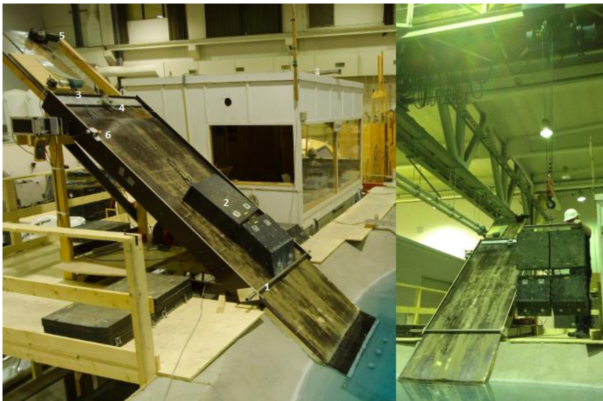
Figur 3-3: V.S.: Skredrampen med skred i hvileposisjon. (1) Sperrestang, (2) Skredelementer, (3) Hastighetsmåler, (4) Utløsermekanisme, (5) Vinsj, (6) Skredsensoren. H.S.: Skredelementene løftes på plass ved hjelp av en tak kran.
