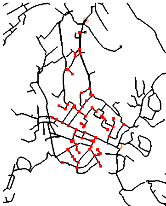
Figur 7 Noder som forsynes av lavtrykksbassenget og er i sonen kalt "Lavtrykk"
