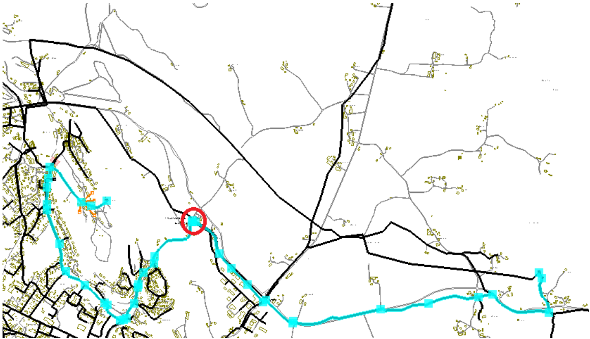
Figur 12 Støtte 150mm overføringsledning fra Høytorp til Revhaug
