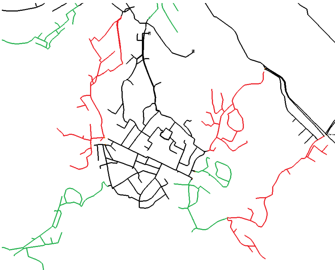
Figur 32 Områder med lavere leveringssikkerhet. Rødt skyldes stengte ventiler, grønt er områder med grenssystem.
