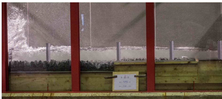
Figur 4.2: Eksempel på forsøk ved Q = 495 \text{ l/s}
