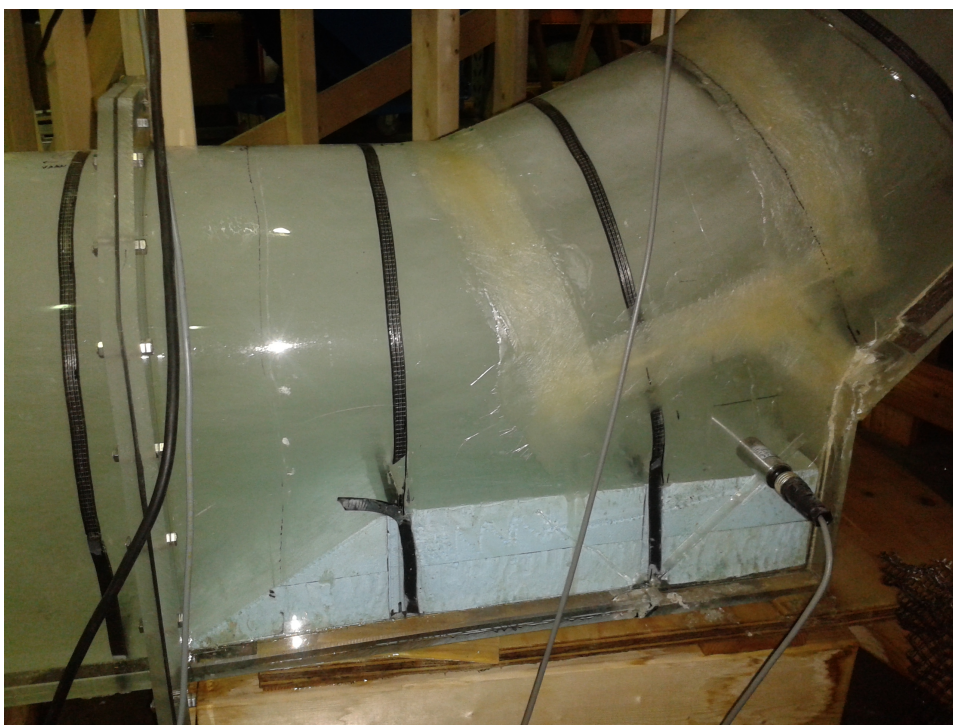
Figur 4.9: Isopor i overgangen sjakt/tunnel
