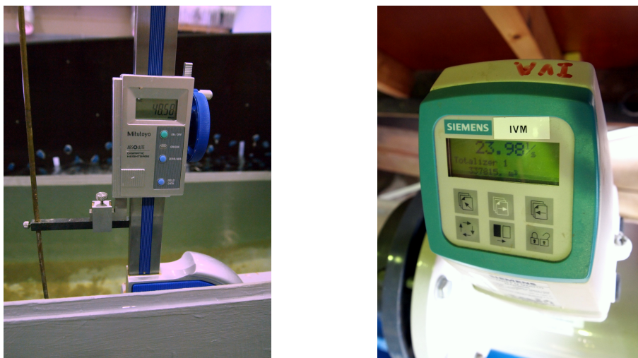
Figur 3.7: Måling av vannstand (venstre) og vannføring (høyre)
