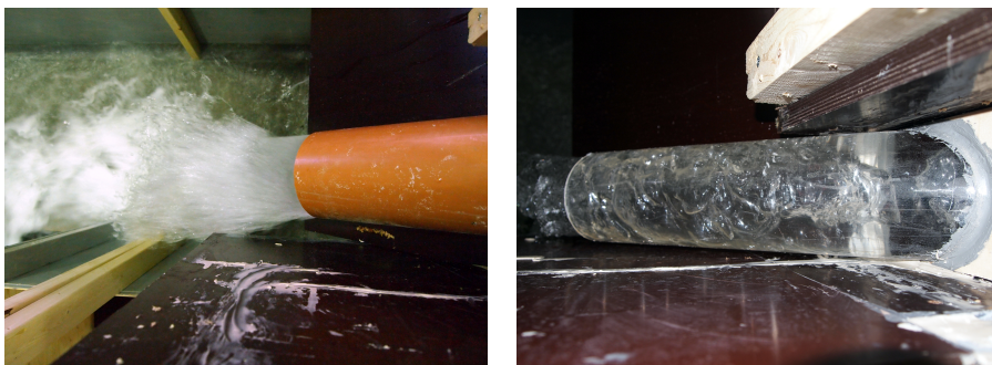
(a) Sjaktutløpet. Vannet har en tydelig rota- (b) Luft i rør. Dette er en situasjon med „fri- sjon, noe som er forårsaket av sidekanalen. speilstrømning”.
