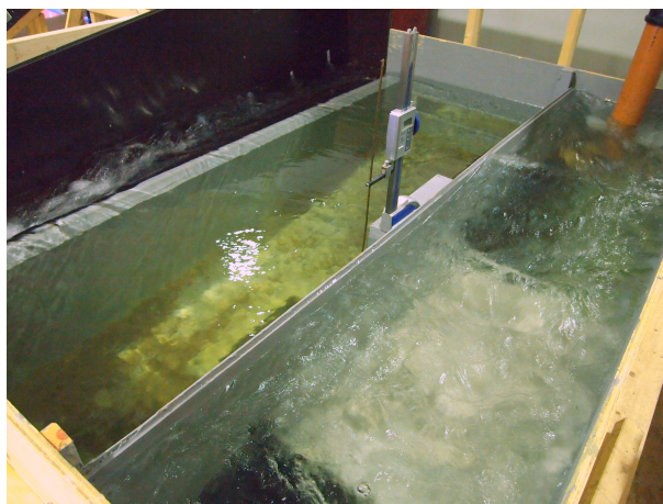
Figur 3.5: Modellen. Vannet kommer inn i kammeret til høyre, passerer tre lag med perforerte plater og strømmer over overløpsterskelen til venstre. På dette bildet går det 160 l/s over terskelen.
