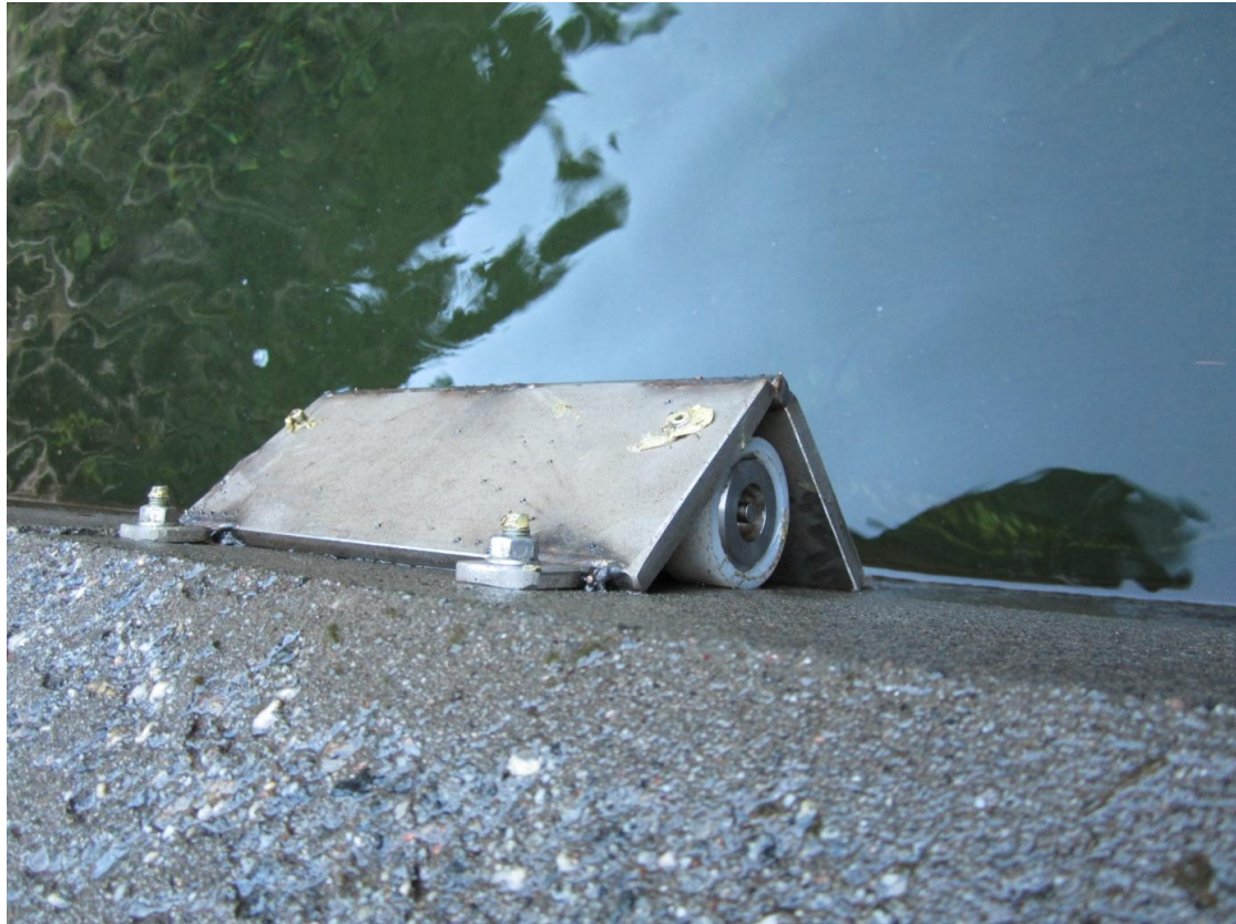
Figur 9: Plassering av SBE 39 på inntaksdam (Foto: H. Opaker)
