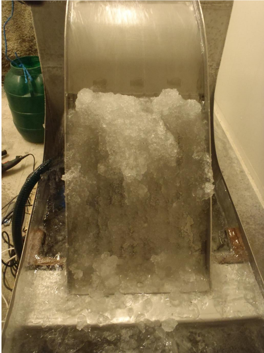
Figur 43: Islag ved slutt av forsøk – 5 °C (Foto: H. Opaker)
