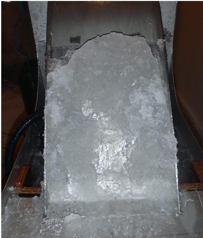
Figur 44: Islegging ved slutt av forsøk - 7 °C (Foto: H. Opaker)
