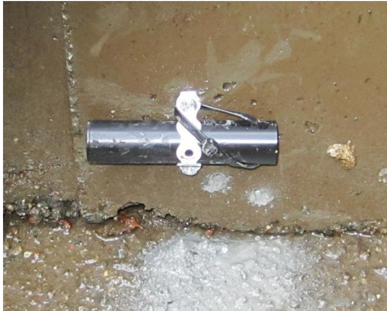
Figur 8: Minilog-II på veggen i reguleringskammer nede ved betongsåle (Foto: H. Opaker)
