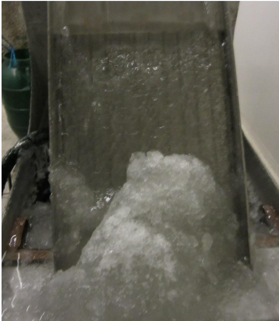
Figur 47: Islegging ved slutt av forsøk -15 °C (Foto: H. Opaker)
