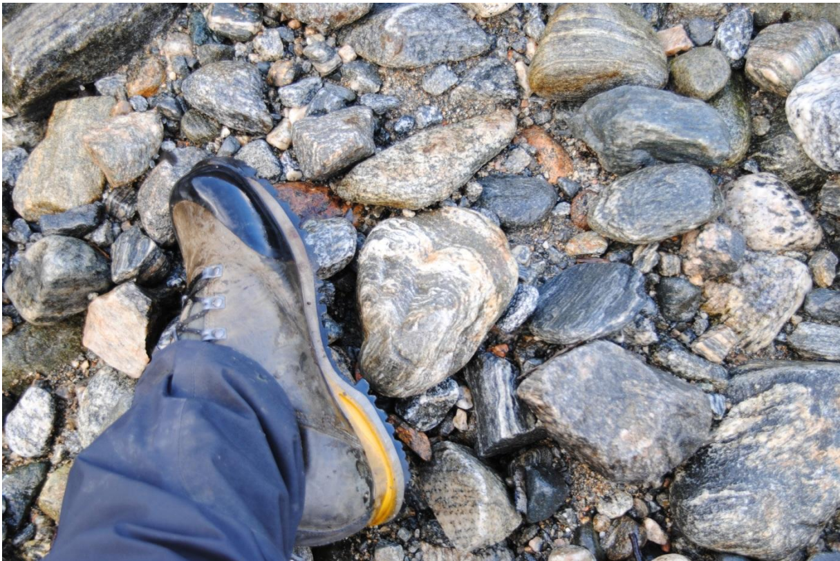
Figur 12 Illustrasjon av ruheten på elve- og magasinbunn. Støvvelsålen er 0,31 m lang.
