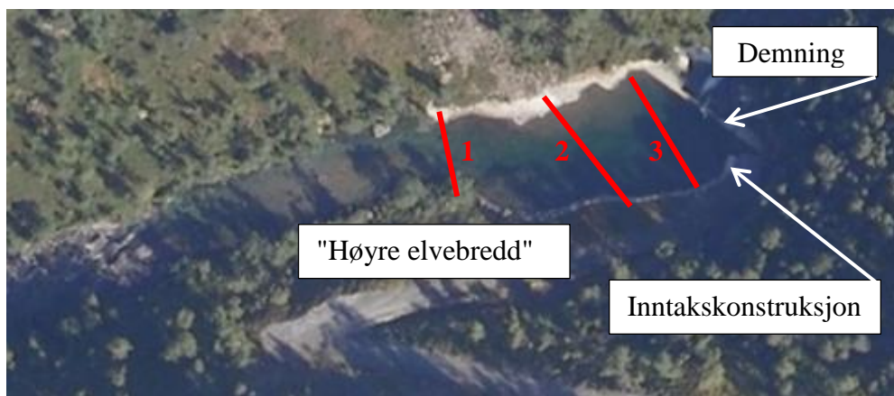
Figur 6 Flyfoto av inntaksmagasinet til Juvfossen kraftverk med plassering av tverrsnitt, demning, inntakskonstruksjon og definisjon av hvilke siden "høyre elvebredd" er.
