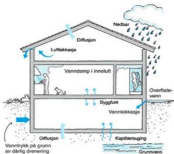
Figur 15: Utfordringer med fukt i boliger (SINTEF Byggforsk, 2016)
