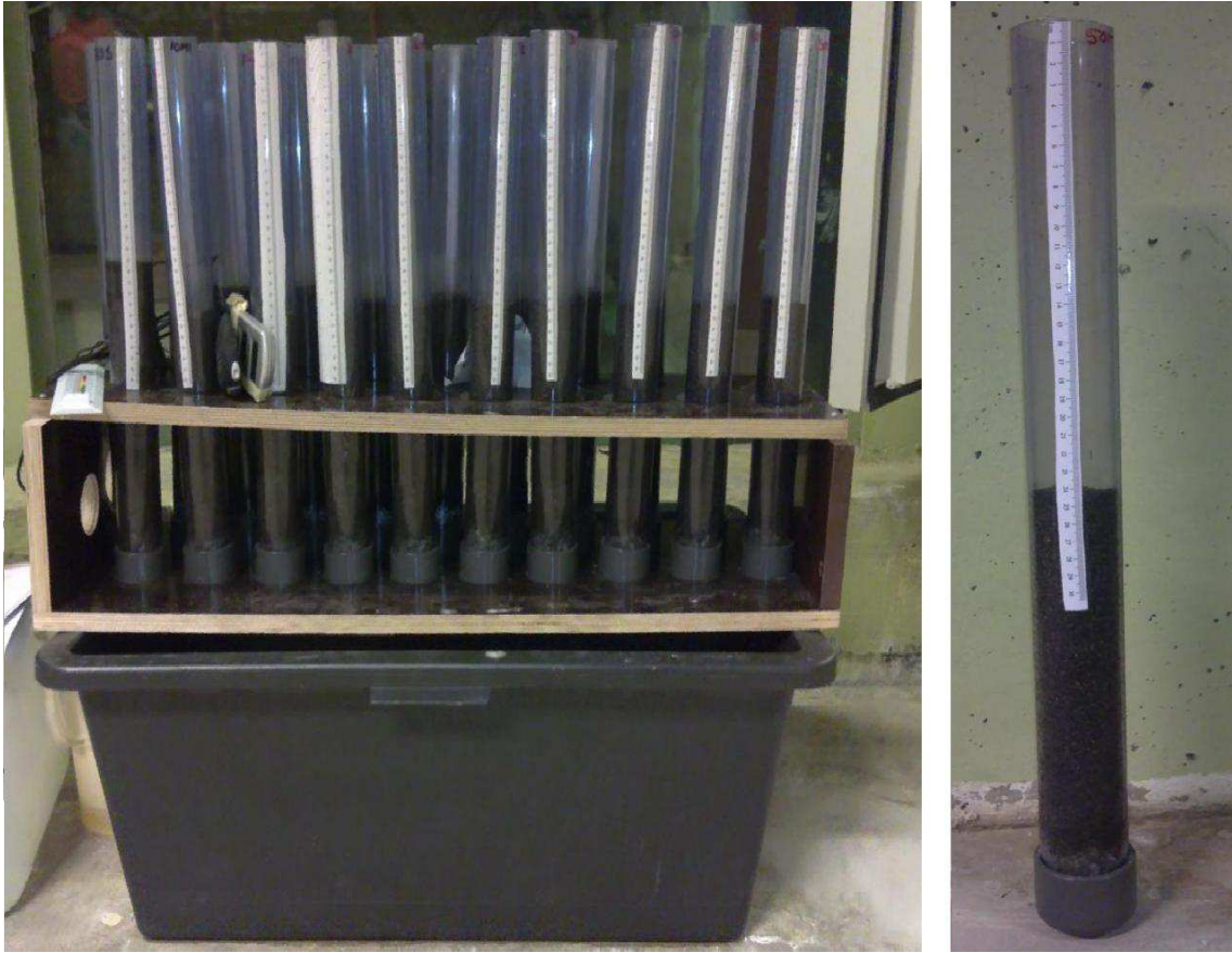
Figur 13: Forsøksoppsett, kolonne med filtermediet samt plass til vann på toppen. Foto: Torstein Dalen
