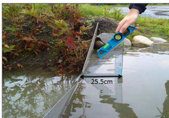
Figur 8: Manuell kontroll av vannhøyden foran V-overløp
