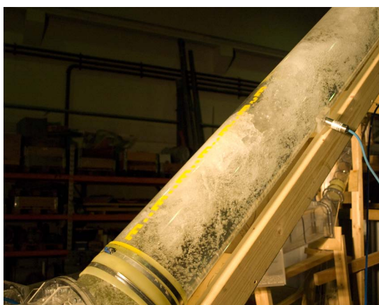
(a) Erosjon nedstrøms luftputa
