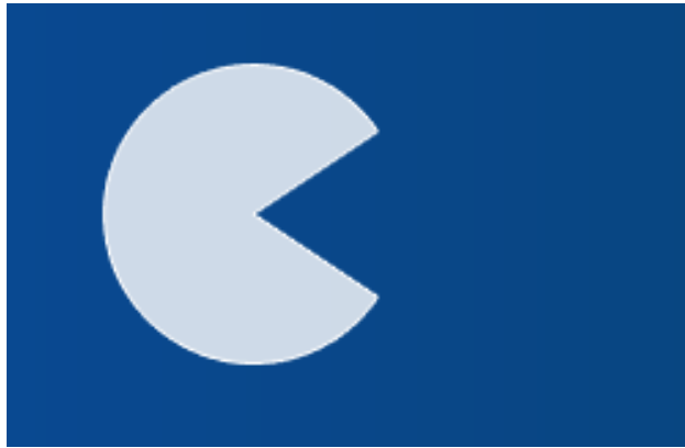
Figur 3.3: En form etter utført boolsk operasjon «NOT». Her er overflaten fra den andre formen subtrahert fra den første.
