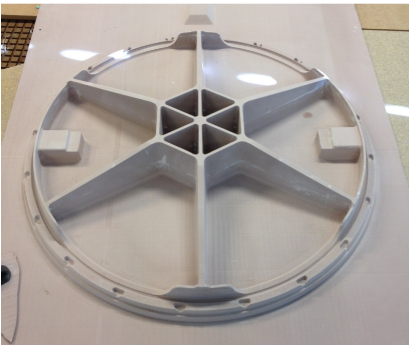
Figur 34: Modellen til lokkets underside limt og ferdig pusset.
