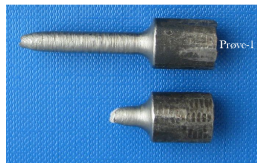
Figur 65 Prøvestav-1 med ru overflate
