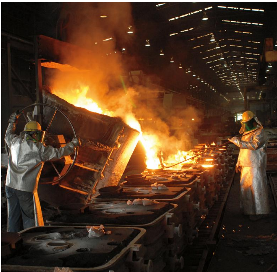
Figur 25 støping av stål i et smelteverk.
