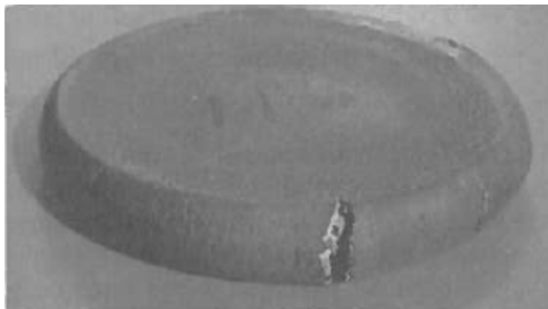
Figur 13 sprekkevekst ved oppvarmet stålemnet i sylinder kompresjon[6].
