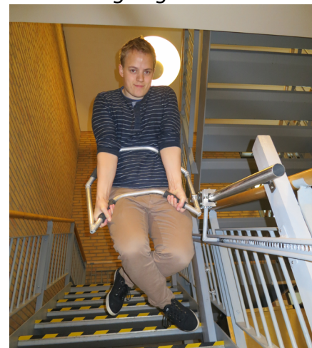
Person på 85 kg som henger hele kroppsvekten på støtten.
