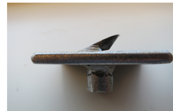
Bilde av hoveddelen av stoppmekanismen, med skråtapp.
