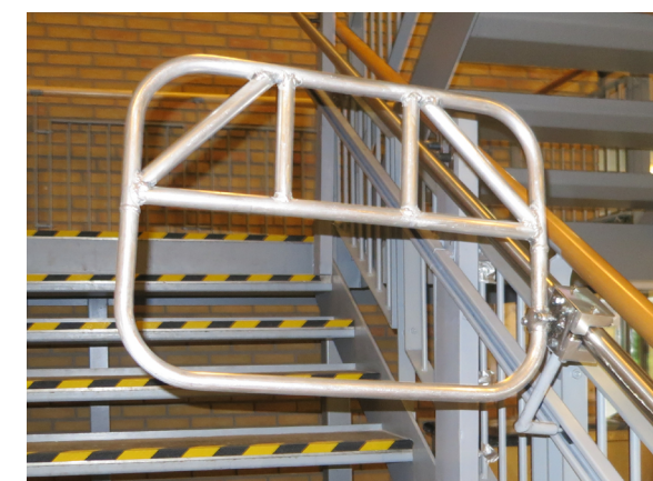
Selve støtten med stopp og forflyttingsmekanisme.
