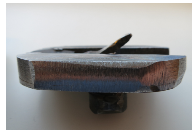
Bilder av stripstappen som ble laget i verkstedet, som funksjonsmodell. Tappen skrues enkelt på L-staven.
