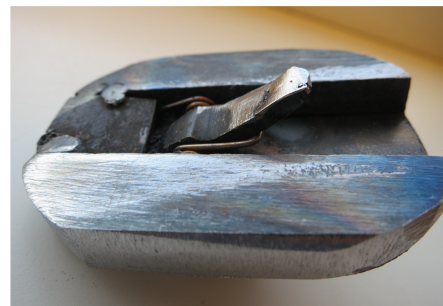
Bilder av stripstappen som ble laget i verkstedet, som funksjonsmodell. Tappen skrues enkelt på L-staven.
