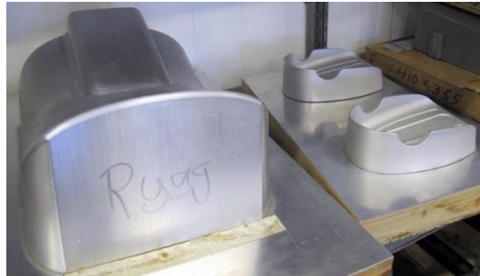
Figur 4-6 Aluminiumsplugg montert på underlagsplate for formingsmaskinen
