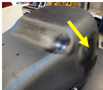
Figur 8-6 Sete utvidet ved hofteknutene for å gi plass til større hoftebredde
