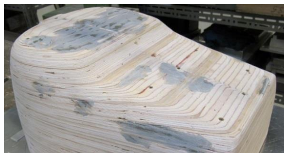
Figur 3-9 Plugg i kryssfiner tørker ut og må sparkles
