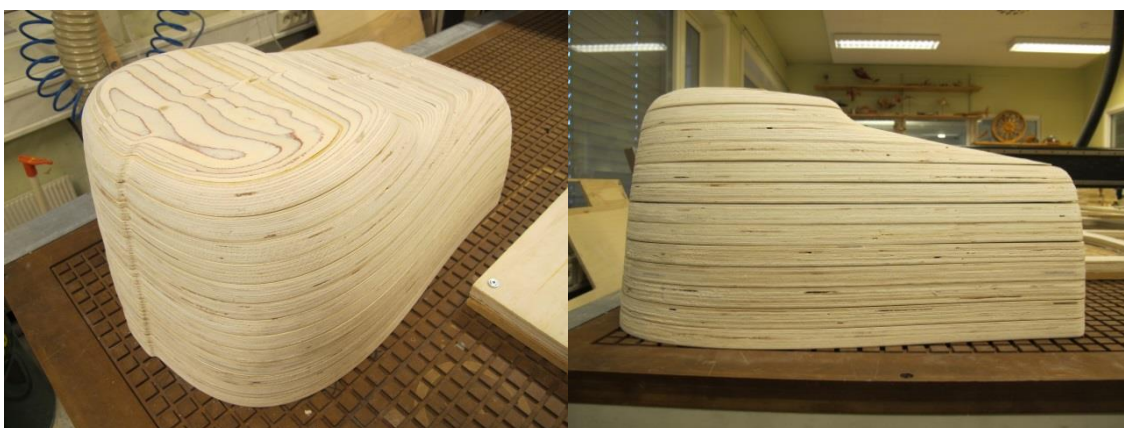
Figur 8-9 Ferdig plugg etter fresing
