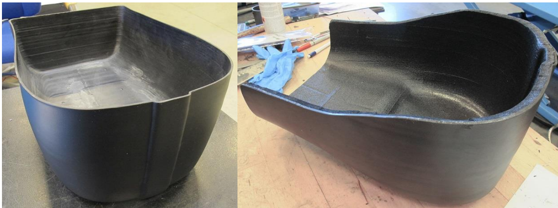
Figur 10-2 Tilpasning av setelengde, fremre høyde og rygghøyde ved hjelp av kapping
