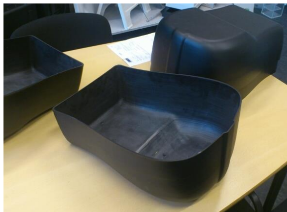
Figur 8-5 Formede seter grovskåret før siste tilpasning
