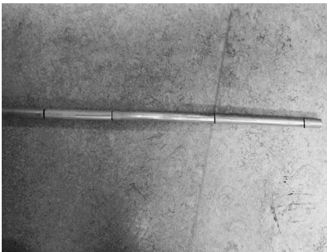
Figur 5.1: Stangekstrusjon med uventet mønster, bamboing.
