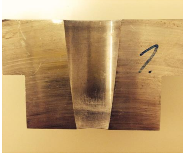
Figur 2.11 En oppdelt del av en innsats viser at det er tre ulike soner langs bæreveggen. En blank og fin flate nederst ved utgangen, en noe grovere del i midten, og et sort område øverst. Tallet på prøven angir vinkelen på bæreveggen
