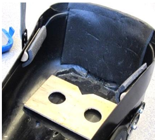
Figur 40 – Funksjonsmodell av sitteplaten i kryssfiner
