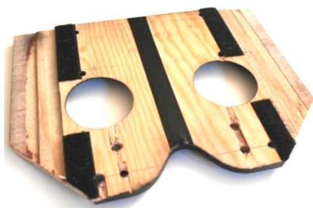
Figur 46 Prototypen av sitteplaten, tilpasset Ballistic-setet, med borrelås i midten og langs sidene
