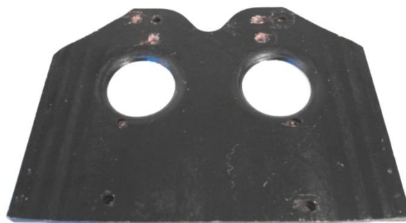
Figur 43 Prototypen av sitteplaten, tilpasset Ballistic-setet, frest ut i kryssfiner med en CNC-fres
