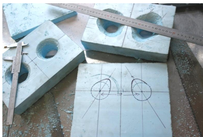
Figur 41 Bygging av funksjonsmodeller med ulik form på hullene til sitteknutene
