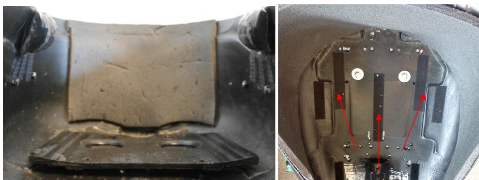
Figur 47 – Ballistic-setet sitteplate og borrelås til sitteplatekobling
