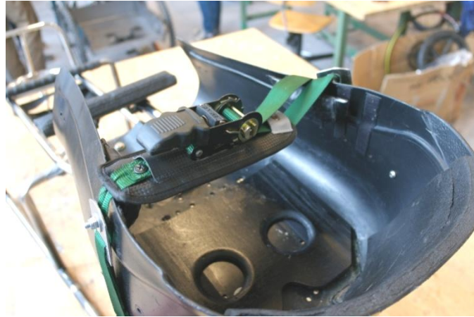
Figur 60 - Stroppe med kraftig strammemekanisme og bred kontaktflate mot utøveren. Sitteplate med hull til sitteknutene
