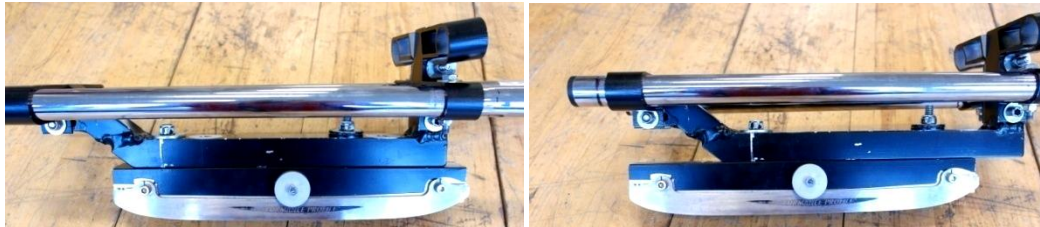
Figur 106 - Den endelige skøytebraketten på Prototype 2 . Her med norske skøytestål da dette ble benyttet på Prototypen
