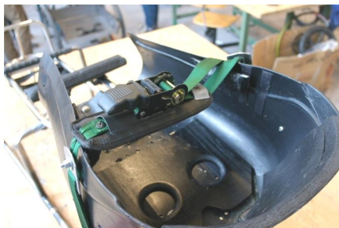
Figur 115 - Stropper med kraftig strammemekanisme og bred kontaktflate mot utøveren. Sitteplate med hull til sitteknutene
