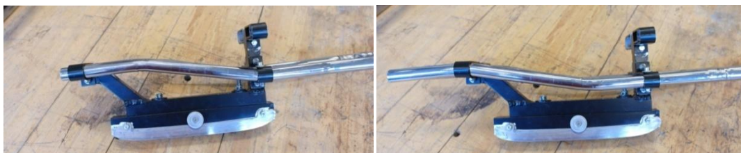
Figur 101 - Høy versjon av ramme på Prototype 2 , justeringsmulighet illustrert
