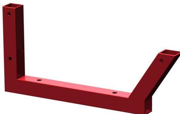
Figur 92 - Endelig utforming av bærende struktur, modellert i NX
