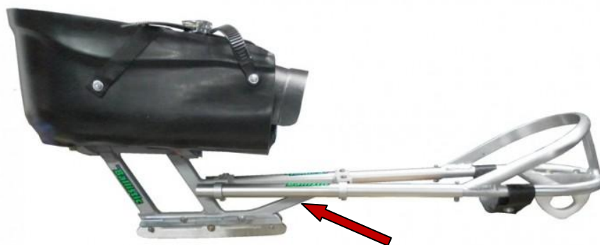
Figur 39 - Understellet på Ballistic strekker seg lenger frem som en følge av at rammelengden ( uniqueinventions.com/ballistic )
