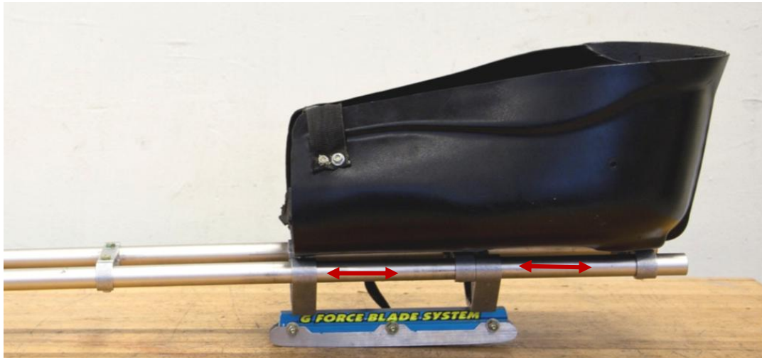
Figur 64 - Justering av setet i x-retning relativt til skøytestålene skjer ved å endre avstanden mellom øvre og nedre braketter (Foto: Emil Kjærnli)
