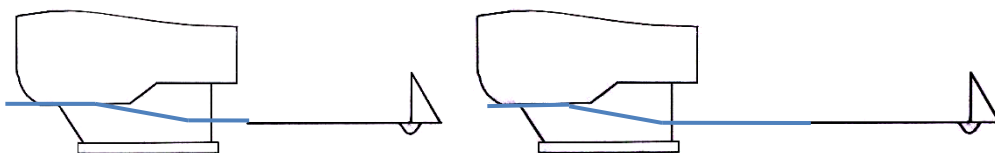
Figur 50 - Den høye rammen må leveres i flere størrelser der "knekkene" er plassert i ulik avstand fra fotbøyle
