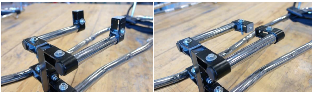
Figur 94 - Knestøtten kan få to ulike høyder ved å vri rammeholderne
