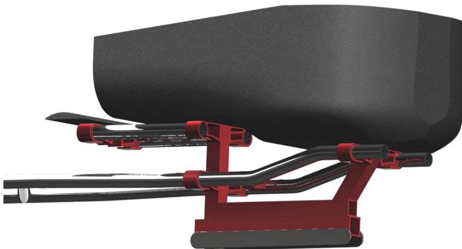
Figur 109 - Ferdig understell med sete og knebøyle påmontert. Modellert i NX
