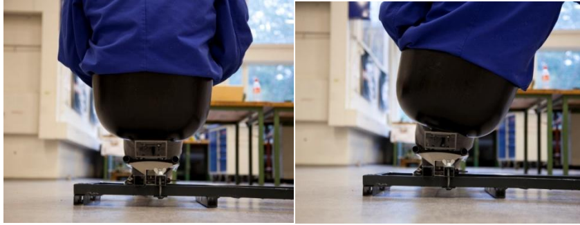
Figur 7 – Utbøyning på den norske kjelken (Foto: Emil Kjærnli)
