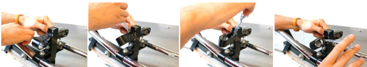
Figur 86 - Ved grovskruing kan rammeholderen roteres sammen med fastnøkkelen
