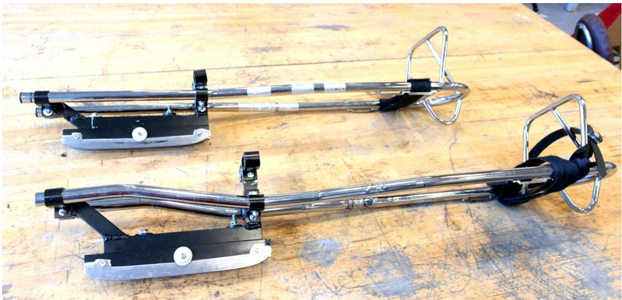
Figur 111 - Understell til Prototype 2 i to høyder
