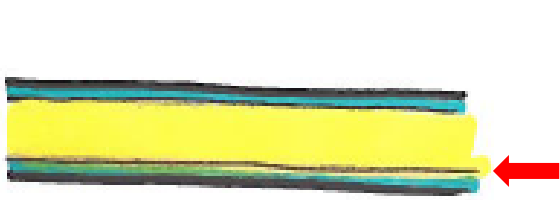
Figur 13 - Tverrsnitt, limlag indikert av rød pil
