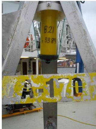
Figure 4.5: Transponder tower (“AUR-Lab Deployment av LBL nett ved TBS”, 2013)
