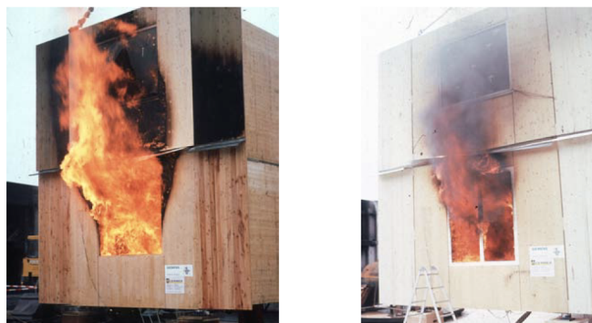
Figur 4.6: Utvendig brannutvikling etter 7 minutter. Venstre: Modul med brennbare overflater, høyre: modul med ubrennbare overflater [20]
