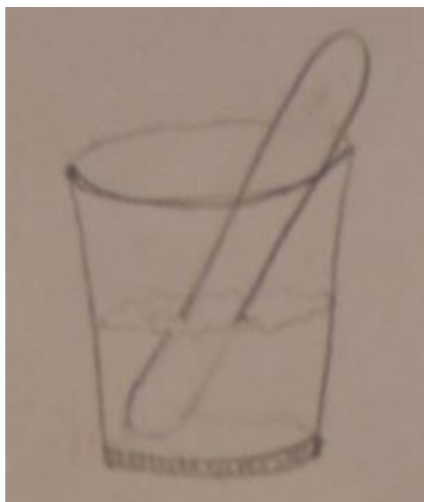
Figur B-III: Blanding av innstøpingsmasse med rørepinne.
