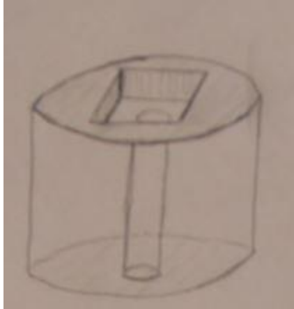
Figur B-VIII: Ferdig prøveholder (figuren er snudd opp-ned i forhold til tidligere figurer).
